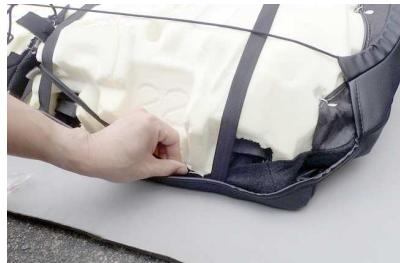
34 金属フックはシートの付け根側に引っ張りシート裏のスポンジ部分からうっすらと見えている金属フレームに引っ掛けて固定します。
