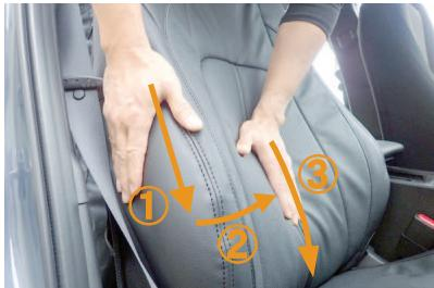
7 ①～③の順番に、カバー側面の生地を引き下げながら中央へ寄せ、中央で余った生地を下へ撫で下ろします。シートの下に余った生地を6番と同様にシート裏から引き出して、生地をシートに密着させていきます。
