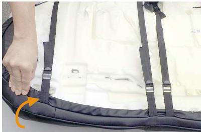
31 ヒモを結び留めたら、シート裏に回っている生地がしっかりシートの裏を覆っているか確認して下さい。シートの側面辺りで生地が反り返っている場合があります。その場合はシートの裏へ生地が来るよう調整して下さい。
