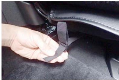
16 引き出したベルトを4番で引き出した生地の端に付いているバックルに通して固定します。
