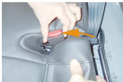
47 シートベルトバックルをシートのフチに通します。
