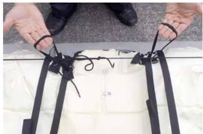
32 シートベルトバックルを通すシートのフチ部分から、カバーの端に付いているゴムを引き出します。
