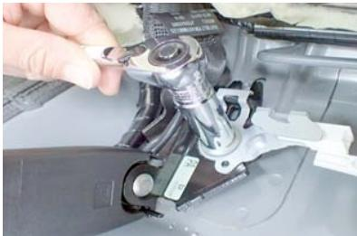
15 シートベルトと車体を固定しているボルトをソケットレンチなどを使用して外します。
