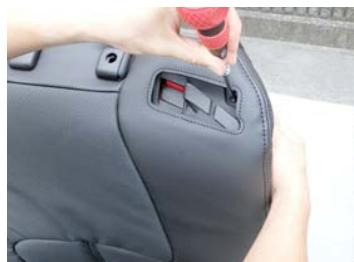
5 シートベルトのガイド部分に付いているネジを、ドライバーを使用して緩めます。
