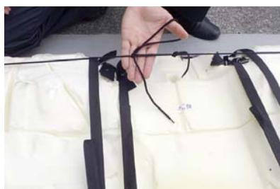
30 通したヒモを引くことでカバーの前・左右が引き締められます。ヒモを緩まないように結び留めます。
