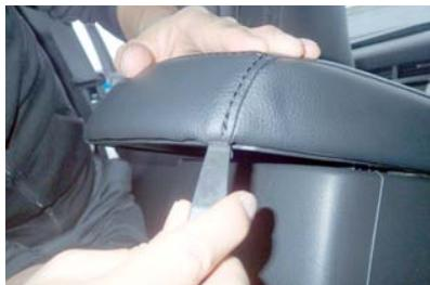
7 コンソールの後ろ側の図の生地の縫い目部分は、生地を入れ込むのが一番きつくなっています。生地に傷を付けないように、慎重に作業を行って下さい。
