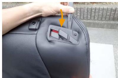
6 シートベルトのガイドとシートの隙間にへラなどを使用して生地を入れ込みます。
