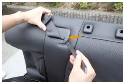
8 シートと中央のシートベルトが出ているプラスチック部の隙間に、ヘラなどを使用して生地を入れ込みます。
