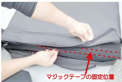
18 カバーの端に付いているマジックテープをシートの端に直接貼り付けて固定します。
