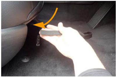
13 カバーの前側に付いている2本のベルトをシートの裏側を通してシートの背面へ入れ込みます。
