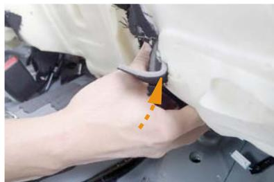
16 ボルトを外すとシートベルトの固定が外れます。シートのフチにシートベルトバックルを入れ込みます。
