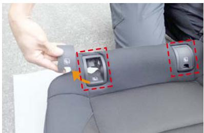
21 赤枠で囲んでいるチャイルドシート固定用フックのキャップを外します。
