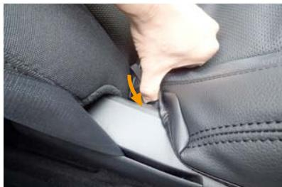
7 ゴムとゴムが付いている生地の端をシートの隙間に入れ込みます。シートの形状に沿わせるようにして、生地を入れ込んで下さい。
