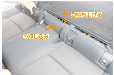
20 ①シートをラゲッジ側に少し押し込み、②シートの付け根を持ち上げるとシート裏のフックが外れます。これでシートと車体の固定が外されました。
