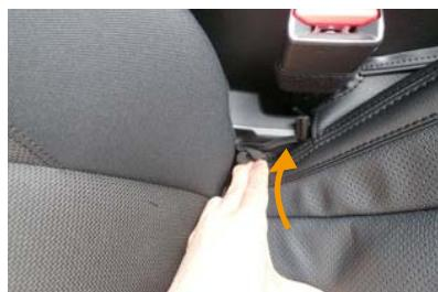
8 シート内側も同様に、ゴムとゴムの付いた生地の端をシートの隙間に入れ込みます。
