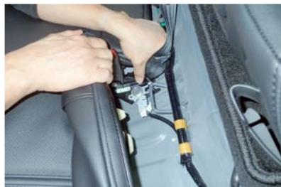
46 シートベルトバックルを車体との固定位置に合わせます。
