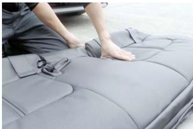
25 シートベルト/バックルの収納部にも生地を馴染ませるようにしてカバーをかぶせます。
