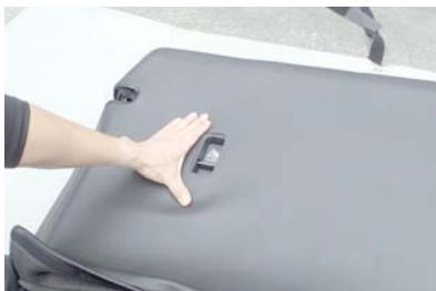
16 シート背面のチャイルドシート固定用フックの位置とカバーの加工穴の位置が合っているかを確認します。ずれている場合はカバーの装着がずれてしまっているので、再度調整して下さい。
