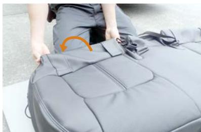
24 シートの付け根部分に、生地を巻き込むようにしてカバーをかぶせます。
