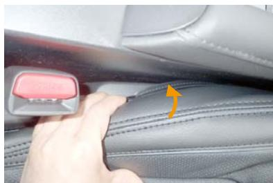
12 シートの内側も同様に、端に固定部材の付いた生地をシートの隙間に入れ込み固定します。
