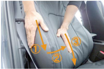
7 ①～③の順番に、カバー側面の生地を引き下げながら中央へ寄せて、中央で余った生地を下へ撫で下ろします。シートの下に余った生地を6番と同様にシート裏から引き出して、生地をシートに密着させていきます。
