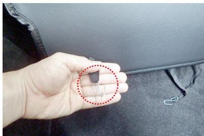
11 カバーの背面下に付いているゴムに付属の金属フックを取り付けます。金属フックはシート裏の金属部分に引っ掛けで固定します。フックの固定は特に指定の位置はありません。ゴムが適度に引っ張られる位置に引っ掛けで固定して下さい。
