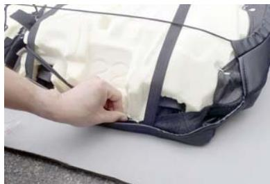
34 金属フックはシートの付け根側に引っ張りシート裏のスponジ部分からうっすらと見えている金属フレームに引っ掛けて固定します。
