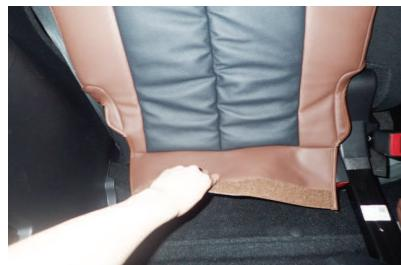
6 カバー下部の生地をシートの隙間に入れ込みます。
