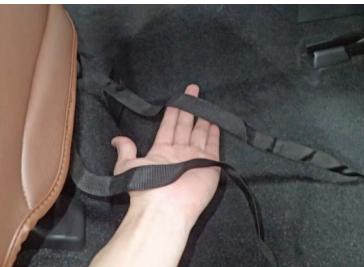
13 カバー前側に付いているベルトをシート裏を通じて、背面に回します。
