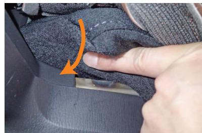
5 純正シートのクッションとプラスチックカバーの隙間にゴムを通します。
