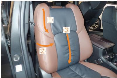
6 図の①～④の手順で、カバーをシートに馴染ませます。①シートラインに沿わせるように生地を流します。②余った生地を中心へ寄せます。③寄せた生地を下に流して、④と同様に背面から引き出します。全体的にたるみや浮きがなくなるまで、この作業を繰り返して下さい。
