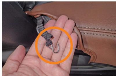
4 カバー側面に付いているゴムに金属フックを取り付けます。
