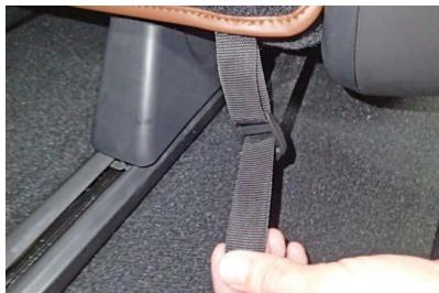
15 シート背面からベルトを引き出し、10ページ3番で引き出した生地に付いている、バックルにベルトを通して固定します。
