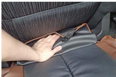
2 背もたれと座面の隙間に生地を入れ込みます。入れ込む部分の生地は2枚重ねになっていますが、2枚とも一緒に入れ込んで下さい。背もたれの角度を調節して入れ込みやすい位置で作業を行って下さい。
