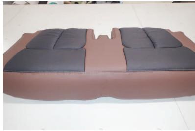
12 カバーのラインを整えて、3列目座面の完成です。3列目の背もたれを装着後、外した逆の手順でシートを戻して下さい。
