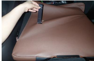
4 カバー背面の加工穴から純正シートのベルトを引き出します。
