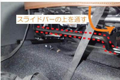
**15** 運転席・助手席手動シート車の場合は、シート下にスライドバーがある為、ベルトを背面に回す作業を行う際は、必ずスライドバーの上を通して下さい。
