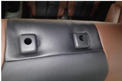
13 ヘッドレストの台座をカバーの加工穴から取り出します。
