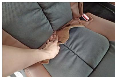
8 背もたれと座面の隙間に生地を入れ込みます。背もたれの角度を調整して入れ込みやすい位置で作業を行って下さい。
