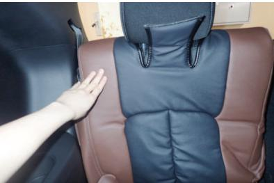
1 カバー背面のファスナーと、中央のプラフックの固定を外します。
