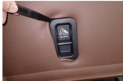
16 シート背面のチャイルドシート用アンカーの隙間にヘラ等を使用して生地を入れ込みます。
