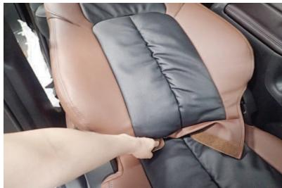
3 座面と背もたれの隙間に生地を入れ込みます。背もたれの角度を調節して、入れ込みやすい位置で作業を行って下さい。
