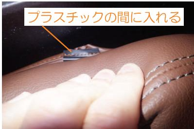
**13** カバー内側（前側）には固定用部材が付いています。ヘラ等を使用してシートのプラスチック部分に入れ込みます。隙間が大きないので、シートを前後させて入れ込みやすい位置で行って下さい。
