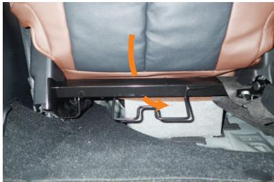
7 図のように座面の軸の上を通して下さい。
