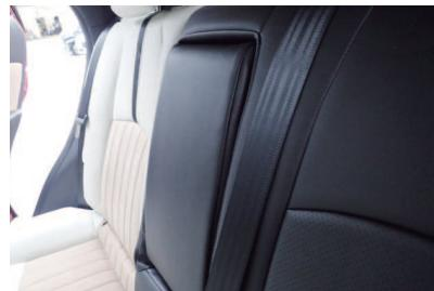
33 カバー装着による生地の厚みが原因で、アームレスト収納時に、シートに対しアームレストに若干の浮きが出ます。予めご了承下さい。
