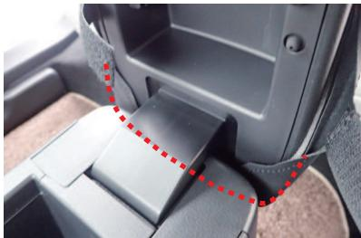
1 アームレストのフタを開いた状態で、アームレスト後端（図の赤線位置）に引っ掛けるようにカバーをかぶせます。
