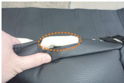
7 シート側の固定用金具を、カバーの加工穴に通します。
