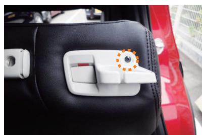
9 シート肩口のシートベルトガイド（プラスチック部）を、カバーの加工穴から取り出し、フチに生地を入れ込みます。
