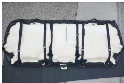
12 シートを裏返し、カバー前後のベルトを固定します。（計6ヶ所）
