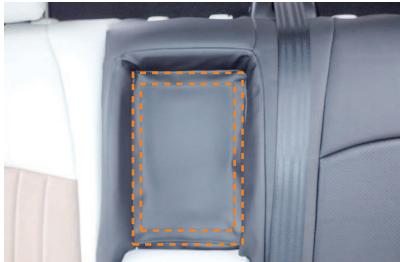
22 アームレスト収納部の形状に沿って、カバーに付いているマジックテープを固定します。マジックテープには保護テープが付いていますので、外してから作業して下さい。
