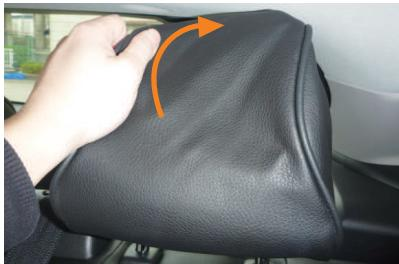
7 2列目ヘッドレストは、前側から後ろ側へかぶせていきます。板状のプラスチックが付いている方が前側です。
