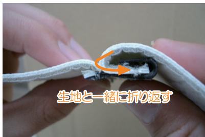
30 ブラフックの固定方法は、カギ状になっているプラスチックに、板状のプラスチックの付いた生地を、生地ごと巻き込むように折り返し、挟み込みます。
