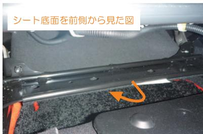
2 生地はシート底面の金属部にプラフックで固定されています。図の矢印方向にプラフックを外すようにすると、生地が取り外せます。
