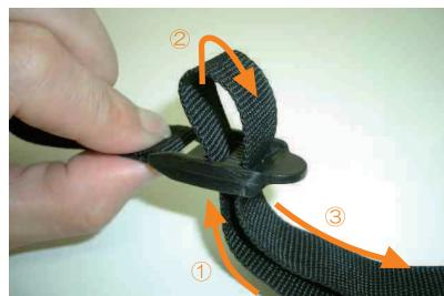
12 ベルトの通し方は、図の①～③の順番にベルトをバックルに通し、前後に引く事でベルトが締まり固定されます。
