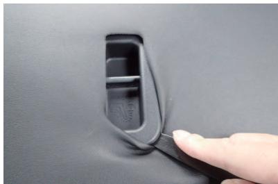
17 シート背面のチャイルドシート固定用アンカー部のフチに生地を入れ込みます。
