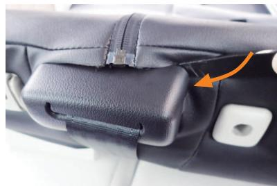
8 中央席用シートベルトの台座をカバーの加工穴から取り出し、台座のフチに生地を入れ込みます。
