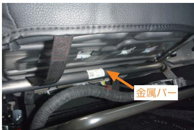
8 カバー前側に付いているベルトを、シート底面を通して後ろ側から引き出します。
