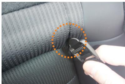
8 図のシート位置にあるチャイルドシート固定用フック取り付け穴（計4ヶ所）に、カバーに付いているベルト固定用バックルを通してます。
