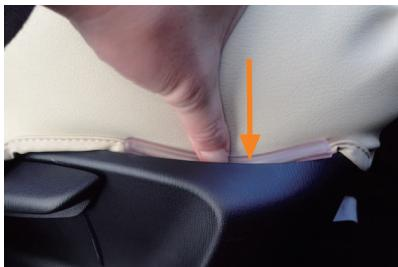
7 カバー外側面の生地に付いている固定部材を、シートとプラスチック部の隙間に入れ込みます。
