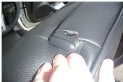
4 ヘッドレストの台座を取り出します。まず台座の片側のフチに生地をしっかりと入れ込みます。
