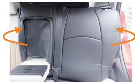
5 シートを左右から覆うように、前側から後ろ側へカバーをかぶせ、シートのラインにカバーを馴染ませます。
