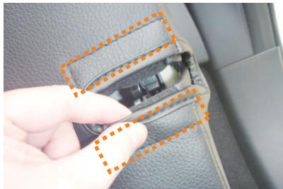
12 シートを車体にロックする部分に、カバーの加工穴を合わせます。穴位置がずれないようにロックする部分のフチに、カバーに付いているマジックテープを直接固定します。
