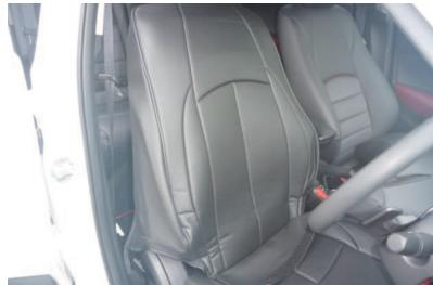
1 カバー両側面に付いているファスナーを開いた状態で、シートのラインに合わせカバーをかぶせます。
