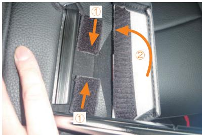
9 ヘッドレストをシートから取り外し、カバー底面のマジックテープを、①の生地同士を内へ寄せた状態で、②の生地に付いているマジックテープで固定します。
