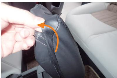
3 アームレスト先端に引っ掛けるようにカバーをかぶせます。
