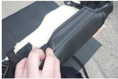
10 カバー後ろ側に付いているマジックテープを、シートに直接固定します。
