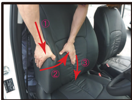
⑪①カバーのラインを整えながら、生地たるみを無くし、②側面の生地たるみを中央へ寄せ、③たるみが出た生地を背もたれと座面の隙間に入れ込み、カバーを馴染ませます。
