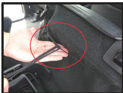
⑥⑤で作った輪に、もう一方のヒモを通し、左右に引き絞って結び留めます。 ※ヒモを強く引っ張りすぎると切れる恐れがありますのでご注意ください。
