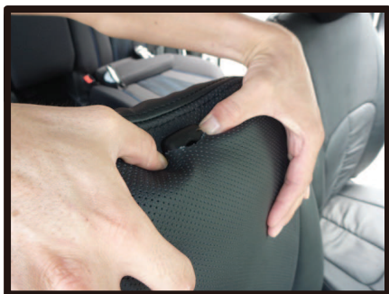
⑨ヘッドレストの台座部分を穴から取り出します。生地伸びを利用して横から潜り込ませるように取り出します。無理に入れると破れる恐れがありますのでご注意ください。
