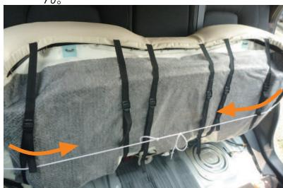
12 カバー両側面のヒモを引き絞り、結び留めます。
