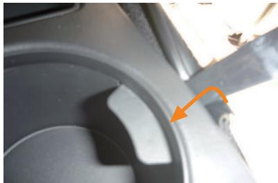
17 カバーに、図のような固定部材が付いている場所は、ヘラ等でプラスチック部の隙間を押し上げるようにして、部材を挟み込むようにします。
