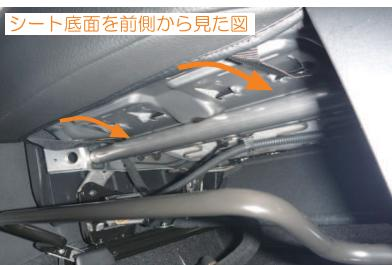
8 シート底面にベルトを通す際は、スライドレバーや金属バーの上側を通すようにして下さい。
