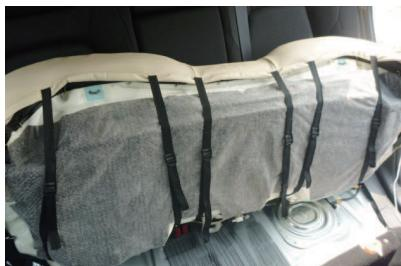
10 シートを図のように起こした状態で、カバー前後のベルトを固定します。（計6箇所）
