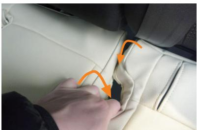
9 助手席側のシートベルトバックル位置の形に合わせ、カバーをかぶせます。
