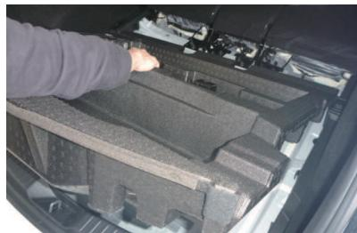
2 ラゲッジボード下の、サブトランクボックスを取り外します。
