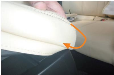
1 1列目アームレストを開けた状態で、カバーを図のように、アームレスト後方に引っ掛けるようにします。
