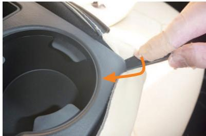
16 アームレスト本体のプラスチック部の隙間に生地を入れ込みます。
