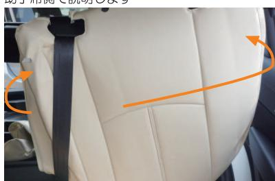
3 カバー背面のファスナーを開き、中央席用シートベルトの下側を通し、シートを包み込むようにカバーをかぶせます。
