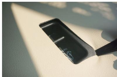
15 背もたれ背面にある、チャイルドシート固定用アンカー部の隙間に生地を入れ込みます。
