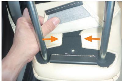
10 ヘッドレストをシートから外し、カバー底面の生地を矢印方向に寄せながら、マジックテープで固定します。
