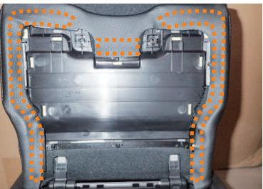
13 アームレストのフタにカバーをかぶせ、図の点線位置に両面テープで固定します。
