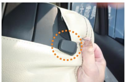
5 背もたれ肩口のリクライニングレバーに付いているシートベルトガイド部(○部)の隙間に生地を入れ込みます。
