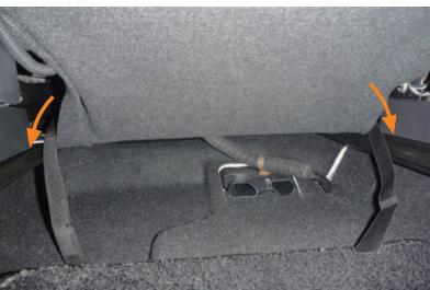
9 底面を通したベルトを後ろ側から引き出す際は、図のようにシート本体を覆う生地の両側面からベルトを引き出します。
