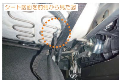
11 金属フックは、6ページ9番のようにシート本体を覆う生地の両側面を通して、シート底面に引っ掛け固定します。
