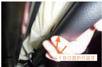
3 2番で確認したシート本体に固定されているプラフックの上から、カバーのプラフックを固定します。
