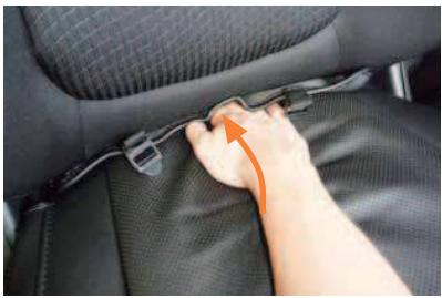
7 背もたれと座面の隙間に生地を入れ込み、後ろ側から引き出します。
