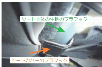
3 シート本体の生地を固定しているプラフックの上から、カバーのプラフックを引っ掛け固定します。
