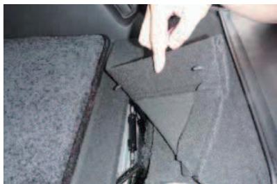
12 背もたれ背面から荷室につながっている生地を図のように取り外します。生地はクリップで固定されていますので、クリップを引き抜くようにすると固定が外れます。
