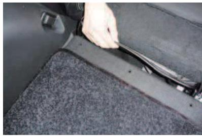
13 12番で外した生地をめくり上げ、カバー前側から通してきた生地を引き出し、マジックテープでシートに直接固定します。
