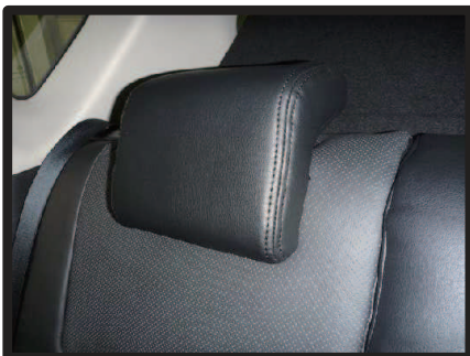
⑤カバーのラインを整えて2列目ヘッドレストの完成です。 2列目中央のヘッドレストも同様に取り付けます。
