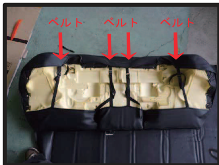
⑩シートを裏返して4本のベルトをバックルに通し、固定します。
