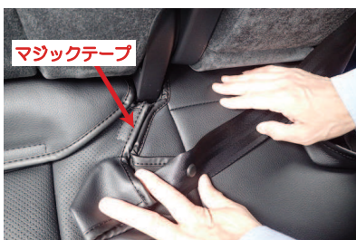
15 9ページ3番でシートベルトをかかわした部分のマジックテープを固定します。
