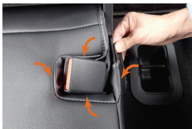
17 内側のシートベルト部分の生地を中に入れ込みます。
