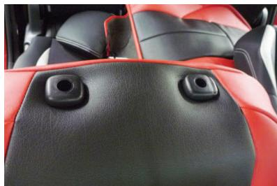
5 本革を使用したカバーは革部分が伸びにいため、取り出す際に生地が裂ける場合があります。大きく裂けない限り台座のフチに噛れますので、大きく裂けないよう慎重に作業を行って下さい。
