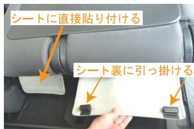
12 引き出した生地（外側の生地）に付いている固定部材をシート裏に引っ掛けで固定します。中央の生地はマジックテープをシートに直接貼り付けて固定します。
