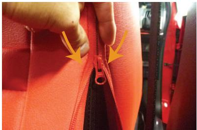
7 背面の左右2箇所のファスナーを生地を内へ寄せながら閉じます。ファスナーの端はカバーの内側へ入れ込みます。
