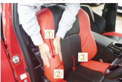
8 ①～③の順番に、カバー側面の生地を引き下げながら中央へ寄せて、中央で余った生地を下へ撫で下ろすようにして、生地をシートに密着させていきます。カバー側面のシワが無くなるまで、繰り返し行って下さい。
