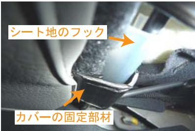
13 固定部材はシート地を固定しているフックの上から固定します。
