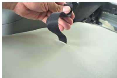
5 シート背面のベルトをカバーの加工穴から取り出します。
