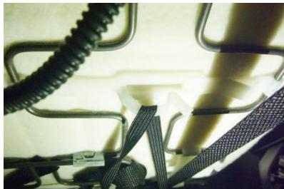
10 カバー背面下の生地に付いている2本のゴムをシート裏の配線などが干渉しない場所に引っ掛けで固定します。
