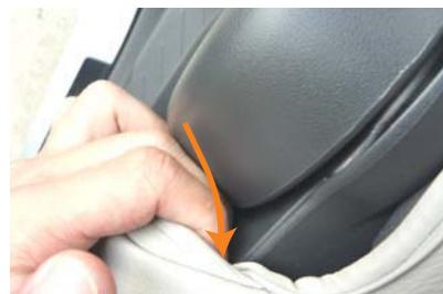
11 シート側面の付け根部分です。生地を隙間に食い込ませるように入れ込みます。
