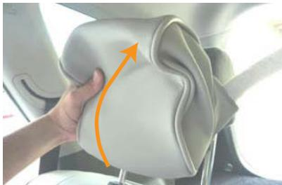
5 2・3列目ヘッドレストは、ヘッドレストの先端部分から矢印の方向へかぶせます。
