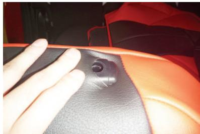
4 カバーの加工穴から生地の伸びを利用してヘッドレストの台座を取り出します。
