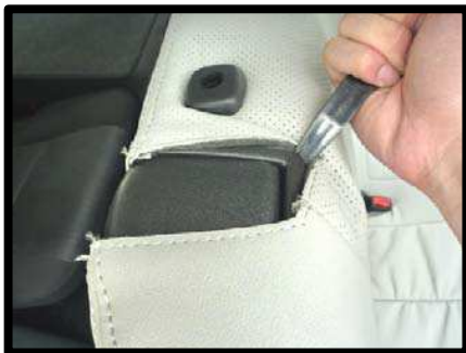
⑭シート肩口のレバーのフチに生地を入れ込みます。ヘラなどを使用して作業を行なって下さい。
