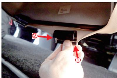
8 オットマン先端の裏側です。カバーにはフック状の固定部材が付いています。フックをシートのフチに引っ掛けて固定します。
