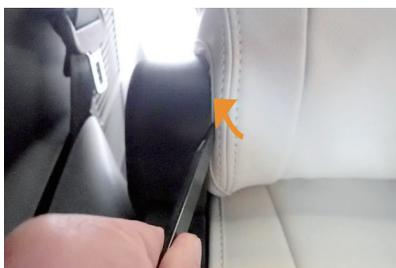
5 シート外側の軸部分です。ヘラなどを使用してシートと軸の隙間に生地を入れ込みます。
