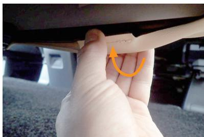
9 フックの①側を先頭に、フックを生地と一緒に180度回転させていきます。この作業を行いながらフックをシートのフチに引っ掛けていきます。①側はシートの裏側に、②側はシートの表側に来るようになります。
