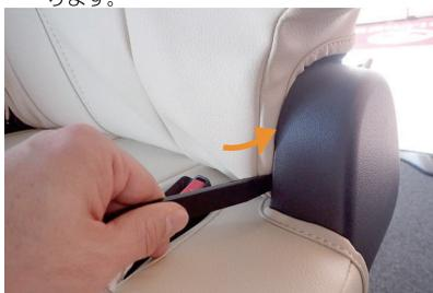
6 シート内側の軸部分です。こちらも外側と同様にヘラなどを使用してシートと軸の隙間に生地を入れ込みます。
