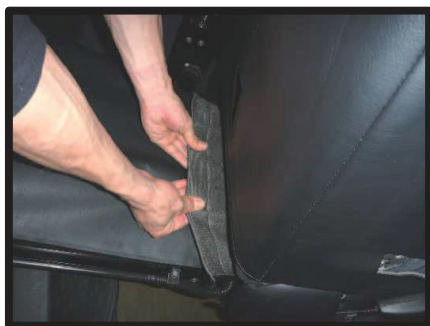
⑥④で入れ込んだ生地を背面から引き出します。
