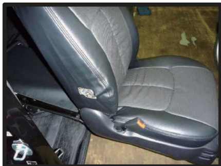
⑤背もたれ背面に作業スペースを空ける為、シート本体を車外まで動かします。
