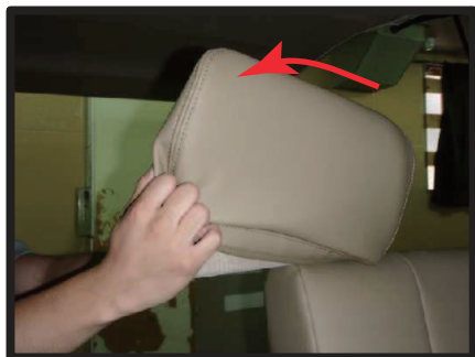
⑩3列目中央ヘッドレストは、図のようにカバーをヘッドレスト側面に引っ掛けるようにかぶせ、生地伸びとヘッドレスト本体を押しつぶすようにしてかぶせていきます。
