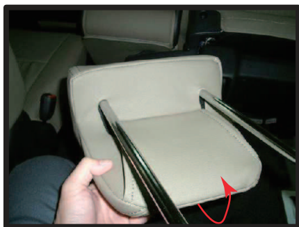
⑨ カバーの下側をヘッドレストに引っ掛けるようにかぶせていきます。ラインを整え、プラフックで固定し3列目ヘッドレストの完成です。
