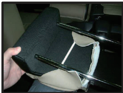
⑦ 3列目ヘッドレストは、台座から取り外し、カバーのゴムの付いた部分をヘッドレストに通します。
