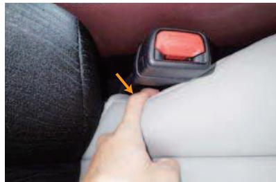
10 シートとシートベルトバックルの隙間に生地を入れ込みます。
