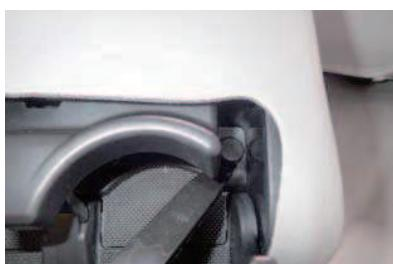
42 ドリンクホルダーのフタを開けます。ドリンクホルダー部分の奥の角に目隠しになるキャップが付いています。キャップをヘラなどを使用して外します。キャップは左右2か所あります。
