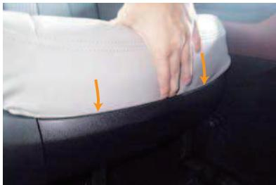
7 前側の生地をシートとプラスチックカバーの隙間に入れ込みます。
