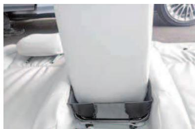
48 アームレストをシートに戻します。軸位置を意識して固定の穴に通します。
