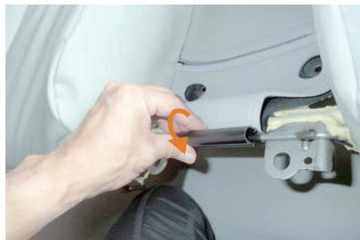
24 アームレスト収納部の下側に純正シート地を固定しているフックの上からシートカバーのフックを固定します。
