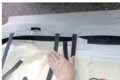
12 ベルトはあまり強く固定しすぎると、シートを車体に戻す際に反発して戻しづらくなります。固定したベルトを手で軽く押さえ、シート裏のクッションに当たる程度に調整して下さい。
