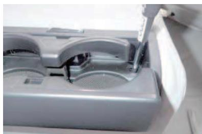
45 外したドリンクホルダーを、生地を挟み込み元に戻します。
