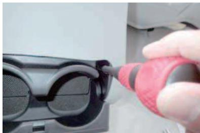
43 キャップを外すとネジが出てきます。そのネジをドライバーを使用して外します。
