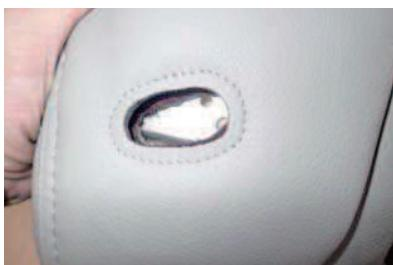
32 シートベルトガイドを生地を挟み込みシートに固定します。加工穴の位置とネジ穴の位置が合っているかを確認して下さい。穴位置がずれている場合はカバーを調整して下さい。またシートカバーを装着したことにより、純正シート地がずれてネジ穴を塞いでしまうこともありますので、その際は純正シート地も調整して下さい。
