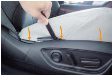
8 ヘラ等を使用し、外側面に付いている固定部材を、シートとプラスチックカバーの隙間に入れ込みます。
