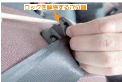
9 シートベルトはシートベルトガイドによって挟み込まれ固定されています。
