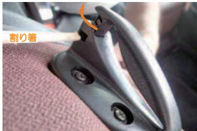
10 シートベルトガイドのロックが外れると、図のようにシートベルトを挟み込んでいたツメが開きます。ツメの隙間を通してシートベルトを外します。この際使用するのは特別な工具は必要ありません。図では割り箸の片方を使用しています。先端が鋭利すぎるものを使用すると、シートベルトガイドのプラスチックパーツに傷が入るので、注意して下さい。
