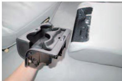
44 ネジを2か所外すとドリンクホルダー部分が図のように外れます。
