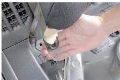
12 シートを車外へ運び出します。この際2番で外したボルトを固定していた図の部分で車体を傷付けたりしないように予め養生テープを巻いたり、要らない生地を巻いたりして対策することをお奨めします。
