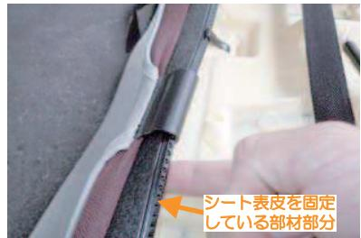
26 カバーの両端に3個ずつ付いているフックを、シート裏の図の部分に引っ掛けで固定します。
