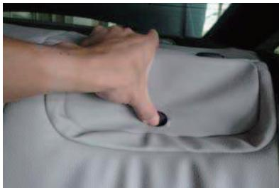
56 プラキャップをカバーの加工穴から通して固定します。
