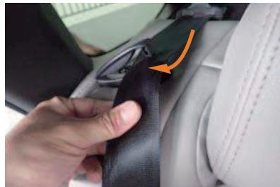
59 シートベルトガイドにシートベルトを通して固定します。
