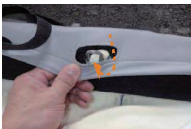
9 シートを裏返して、シート裏のフックにカバーの加工穴を通します。運転席側、助手席側共に穴に通します。
