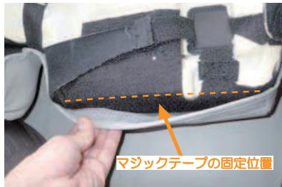
10 シート中央の付け根部分です。この位置のカバーには、生地の裏にマジックテープが付いています。マジックテープを直接シートに貼り付けて固定します。
