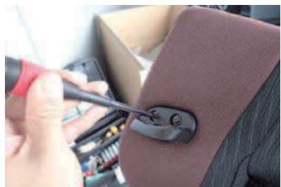
14 シートに3か所付いているシートベルトガイドを外します。ドライバーを使用してネジを外します。
