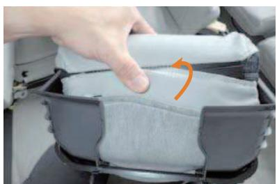
39 アームレストの付け根部分でプラフックを固定します。
