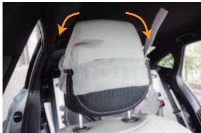
1 カバーを半分程度裏返し、ヘッドレストの先端がきっちり合うようにカバーをかぶせます。
