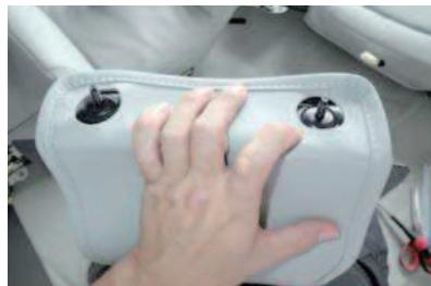
47 アームレストを固定する軸にカバーの加工穴を通します。
