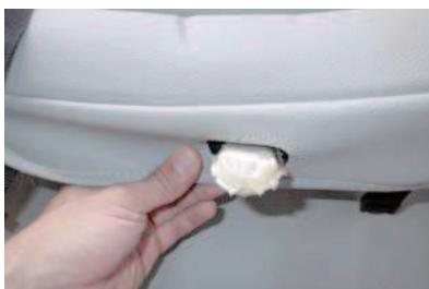
8 シートの付け根にあるコの字型のフックにカバーの加工穴を通します。運転席側、助手席側共に穴に通します。
