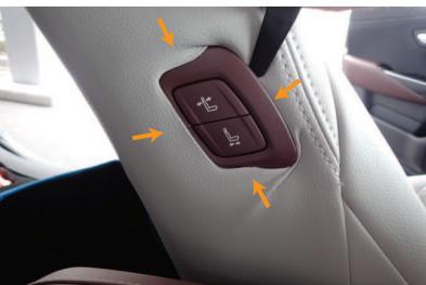
**14** 助手席の内側面にパワーシートスイッチがあるお車は、ヘラ等を使用し、シートヒーターとスイッチの隙間に生地を入れ込みます。
