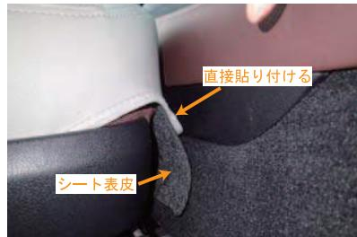
11 カバー内側面に付いているマジックテープをシート表皮に直接貼り付け固定します。
