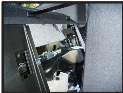
⑧助手席側背もたれを前に倒した図です。カバーをかぶせる際は、背もたれを前に倒して行います。
