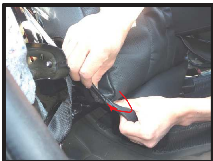
⑭シート外側面の下にカバーを引っかけるようにしてかぶせます。
