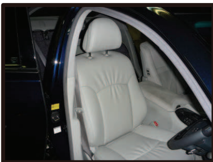
⑧ サイドエアバッグの展開部分とシートカバーのSAB対応の縫い目部分が合っていることを確認して下さい。 カバーのラインを整えます。 ヘッドレストバックボードを元に戻して、1列目背もたれの完成です。 助手席側も同様に取り付けます。
