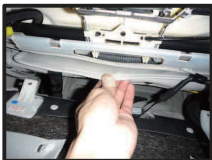
⑨入れ込んだ生地を背面から引き出します。
