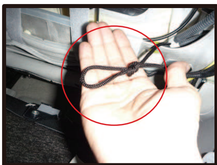
⑥ カバー両端に付いているヒモを後ろ側で固定します。 片側のヒモで輪を作り、反対側のヒモを通して絞り込み固定します。
