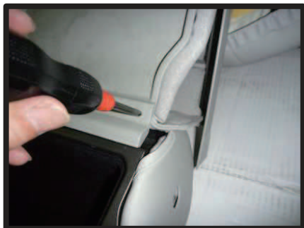
⑨上フタのプラスチックパーツを外します。 ネジをドライバーで外します。ツメで固定されているので、ヘラ等で外します。(各4箇所)
