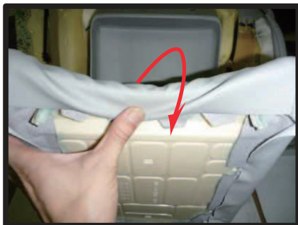
⑪前側の生地も内側まで巻き込み固定します。
