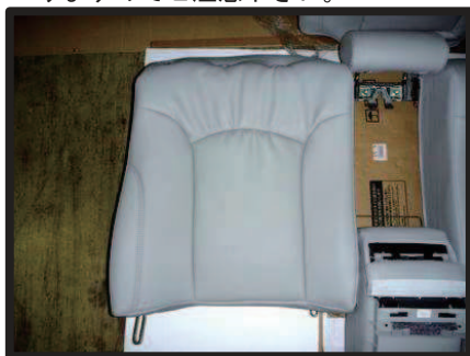
⑮カバーのラインを整えます。2列目背もたれの完成です。助手席側も同様に取り付けます。車体に戻すのは、アームレスト取り付け後に行います。
