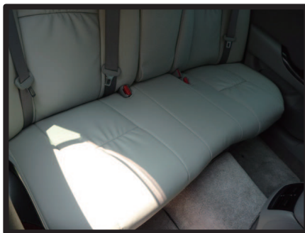
⑦2列目座面の完成です。 シートを車体に戻す作業は、背もたれ・アームレストを完成させた後に行います。
