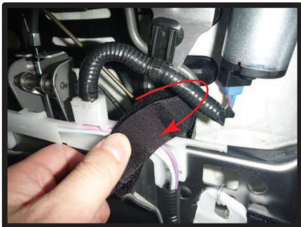
⑧マジックテープのベルトは、図のように金属部に巻き付け固定します。
