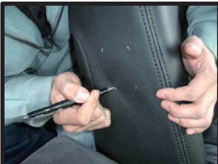
①カバーをきちんと取り付けた状態にします。パワーシートのスイッチ部を手で触りながら角部分から内側に7mmの位置に目印を付けます。
