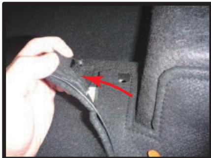
②背もたれを引き倒し、背もたれ背面側に付いている生地を取り外します。生地は図のようにクリップで留まっていますので、真上に引き抜きます。
