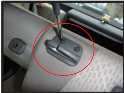
①2列目背もたれの助手席側には、中央席用のシートベルトがあります。シートベルトを台座から外し、台座を+ドライバーを使用し、取り外します。
