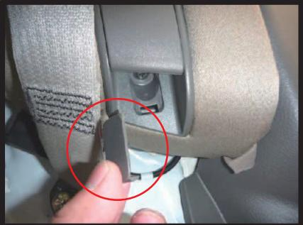
⑰2列目背もたれ下部のリクライニングレバーにあるプラスチックのフタを先の細いものを使用し、取り外します。
