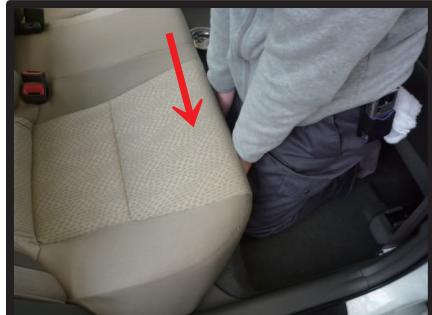
①始めに車体からシートを取り外します。シートは図の矢印の位置に金具で固定されていますので、金具を真上に引き抜くようにして外します。
