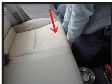
②金具は運転席側と助手席側の2ヶ所で固定されています。①と同様に金具を引き抜きます。
