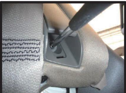
⑲プラスチックのフタを外すと中にネジがありますので、+ドライバーを使用し、外します。
