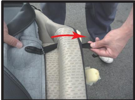
④カバーをシートにかぶせる前に、シートのチャイルドシート固定用フック位置にある穴に、カバーの同じ位置に付いているベルトを通します。
