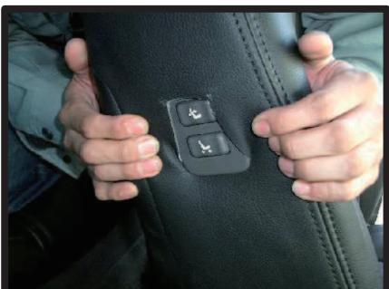
⑤シート本体とスイッチのプラスチックとの隙間に、切り抜いたカバーを入れ込みます。
