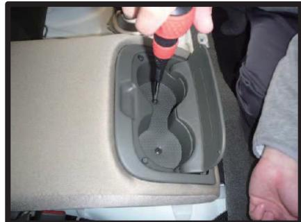
①アームレストのカップホルダー部の中敷きを外すとネジがありますので+ドライバーを使用し外します。ネジを外すとカップホルダーが外せます。
