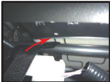
⑧取り出したベルトをシートの下側を通して、後ろ側へ引き出します。
