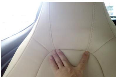
11 図のヘッドレスト下側は、シートの形状でかなりくぼんでいますが、シートカバーでは固定時に上下に生地を引っ張るため、この形状をシートカバーで正確に反映させることは難くなっています。
