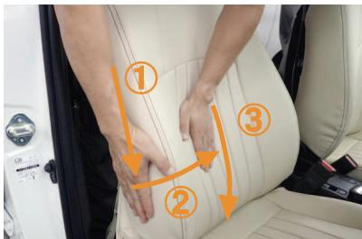
8 ①～③の順番に、カバー側面の生地を引き下げながら中央へ寄せて、中央で余った生地を下へ撫で下ろします。シートの下に余った生地を7番と同様にシート裏から引き出して、生地をシートに密着させていきます。
