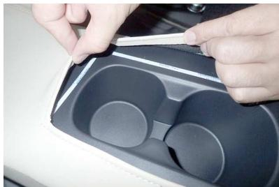
10 ドリンクホルダー周りの生地の浮きを抑えるためには長方形に開けている加工穴の4辺に両面テープを貼り付けます。
