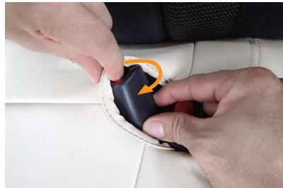
16 中央のシートベルトバックルを頻繁に使用されない場合はカバーの内側へ入れ込んでおきます。加工穴はさほど大きくない為、生地を少し持ち上げながらバックルを入れ込みます。
