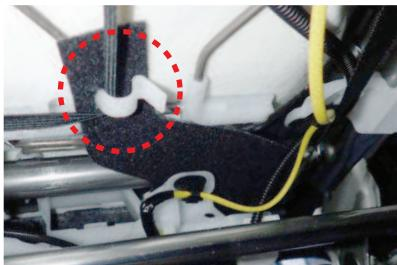
16 ゴムをシート裏の5ページ1番で外した純正シート地を固定していたフック部分に引っ掛けで固定します。
