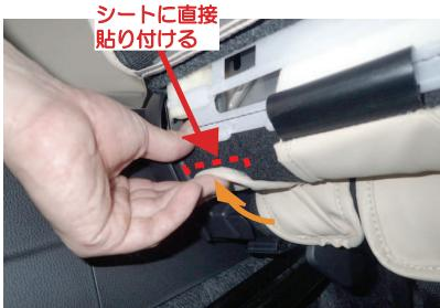
13 7番で引き出した両端の生地に付いているマジックテープを直接シートに貼り付けて固定します。
