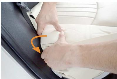
7 シート付け根部分の生地を図のように入れ込みます。生地の端に付いているマジックテープを直接シートに貼り付けて固定します。
