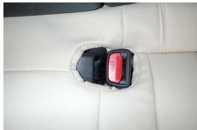
17 中央のシートベルトバックルを入れ込むと助手席側は図のようになります。
