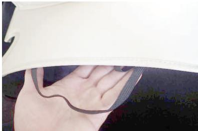
10 カバーの背面下にはゴムが付いています。ゴムをシート裏の5ページ1番で外した純正シート地を固定していたフック部分に引っ掛けで固定します。
