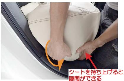
8 カバー側面の生地をシートを包み込むようかぶせていく、シートの裏へ生地を入れ込みます。シート自体を上へ浮かせながら隙間に生地を入れ込み、生地の端に付いているマジックテープを直接シートに貼り付けて固定します。
