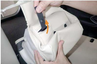
1 アームレストの先端にあるベルトを、カバーの加工穴から取り出します。
