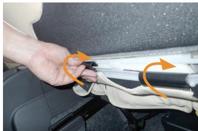
11 7番で引き出した生地に付いているフックを、純正シート地を固定しているプラスチックパーツに引っ掛けで固定します。
