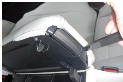
6 アームレストの先端部分に生地を入れ込みます。生地が入れ込みづらい場合は、ヘラのみを隙間にいれ、生地の入る角度を確認してから生地を入れ込むと作業が行いやすくなります。
