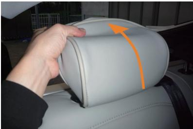
7 2列目ヘッドレストは図の矢印方向に、ヘッドレストのラインに合わせて下から上へかぶせます。カバーは平らなプラスチックが付いている方が前です。
