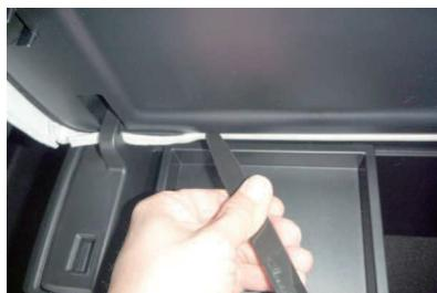
5 ここからはひたすらフチに生地を入れ込んでいきます。ヘラなどを使用して生地を入れ込みます。アームレストのフタを開けた状態で作業をするので、破損させないように生地を入れ込む際は、フタ部分をしっかりと支えて作業を行って下さい。
