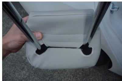
10 2列目ヘッドレストの裏は図のようになります。2列目ヘッドレストはカバーをかぶせやすくするために、軸周りの穴を大きめに開けています。
