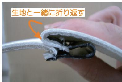
5 プラフックの固定方法は、かぎ状のフックに平らな方のプラスチックを生地と一緒に折り返して、はめ込み固定します。
