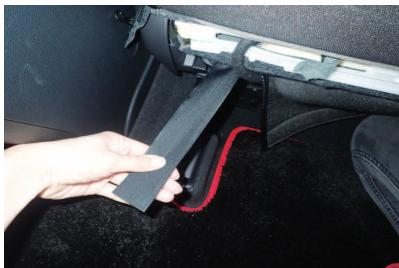
7 5番で入れ込んだマジックテープを引き出します。マジックテープは配線の外側に来るよう中央部分から端へずらし、引き出して下さい。マジックテープ部分は強く引き過ぎると生地が破れたり、縫製糸が切れるので、慎重に作業を行って下さい。
