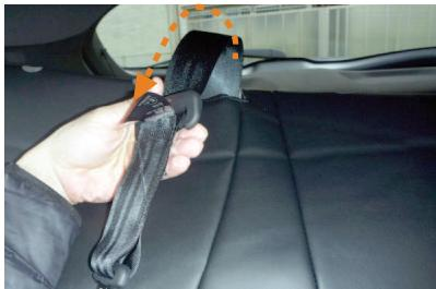
1 カバーの加工穴から中央のシートベルトを取り出します。
