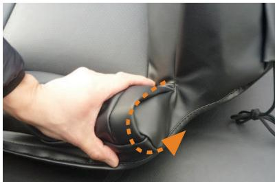
7 シートの付け根部分に生地を馴染ませるようにしてカバーをかぶせます。
