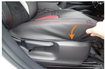
9 外側面の固定用部材を、ヘラなどを使用してシートのプラスチックの中へ入れ込みます。固定用部材が見えなくなるまでしっかりと奥まで入れ込んで下さい。
