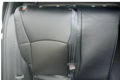
2 カバー内側面のファスナーを開いた状態でシートのラインに合わせて、カバーをシート全体にかぶせます。
