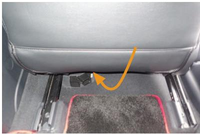
13 カバー背面下のゴムに付属の金属フックを取り付けて、シートの底面に引っ掛けで固定します。
