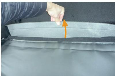
9 シートを前に倒して、入れ込んだ生地を引き出します。シートの両端は生地が引っ掛かりやすくなっているので、しっかりとシートに沿わせて引き出すようにして下さい。座面シートを外しているので、シートを前に倒した際、カバーを傷付けたり、汚したりしないようにご注意下さい。
