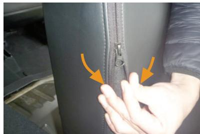
10 カバー内側面のファスナーを生地を内へ寄せながら慎重に閉じます。ファスナーの端はカバーの中へ入れ込みます。
