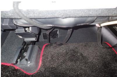
7 6番で背面に回したベルトを、5番で引き出した生地に付いているバックルに通して固定します。
