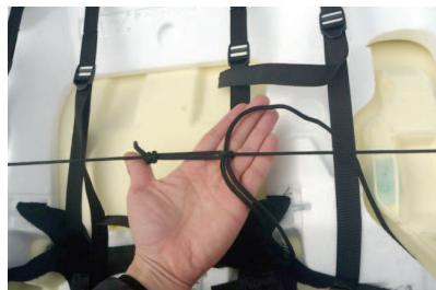
12 作った輪にもう一方のヒモを通します。通したヒモを引き、カバーの下周りを絞り込み結び留めます。
