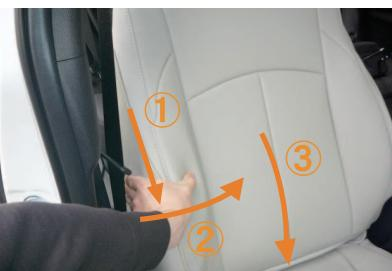
8 図の①～③の手順でシートにカバーを馴染ませます。①シートラインに沿わせる様に生地を馴染ませます。②余った生地を中心へ寄せます。③寄せた生地を下へ馴染ませ
