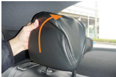
7 2列目ヘッドレストです。2列目ヘッドレストは図の矢印方向に、ヘッドレストのラインに合わせて下から上へかぶせます。カバーは平らなプラスチックが付いている方が前側です。
