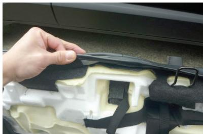
9 シートのフチ（8番の赤線部）にカバーのマジックテープを直接貼り付けて固定します。
