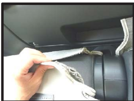
⑥引き出した生地を、カバー背面下の生地とマジックテープで固定します。
