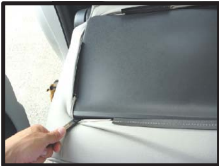
⑧シート背面のバッグボードの隙間に生地を入れ込みます。プラスチックの板を入れ込むことで、生地がはみ出さずに固定されます。
