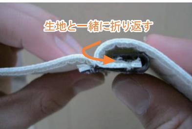
4 プラフックの固定方法は、カギ状のプラフックに板状のプラフックを、生地ごと巻き込むようにはめ込み固定します。
