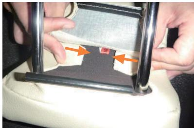
10 ヘッドレストをシートから外し、ヘッドレスト裏で、カバーを内側へ寄せながらマジックテープを留めます。
