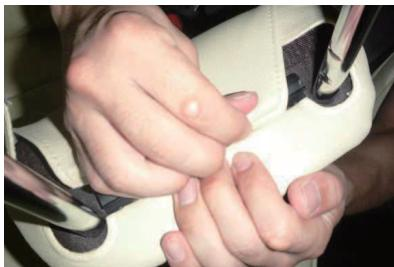
3 ヘッドレストをシートから外します。カバーはヘッドレスト裏でプラフックで固定します。
