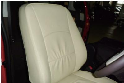
14 サイドエアバッグ装備車は、サイドエアバッグの展開部分とシートカバーのSAB対応の縫い目部分が合っていることを確認してください。
