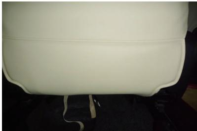
13 カバー背面下部の生地に付いているゴムに付属のS字フックを取り付けシート底部に固定します。
