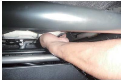
6 入れ込んだ生地に付いているゴムを、シート底面から取り出し、シート底面の金属部分にS字フックで固定します。
