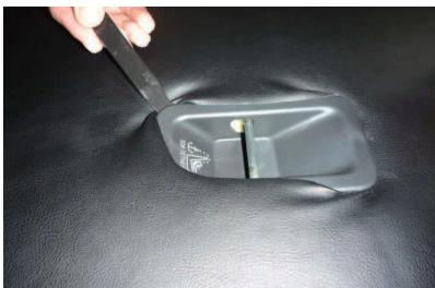
8 背もたれ背面のチャイルドシート固定用アンカーの隙間に生地を入れ込みます。
