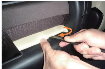
10 8番で引き出した生地には、板状のプラスチックが付いていますので、ヘラなどを使い、9番の○部の隙間に生地ごと巻き込むように入れ込みます。
