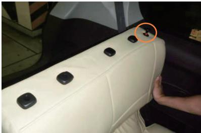
2 1列目と同様に、ヘッドレストの台座を取り出します。この際、同じ要領でリクライニング用スイッチ部もシートの加工穴から取り出します。
