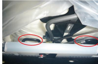
5 ④番で引き出した生地に付いているマジックテープを背面下部の金属部（図参照）に巻きつけて固定します。
