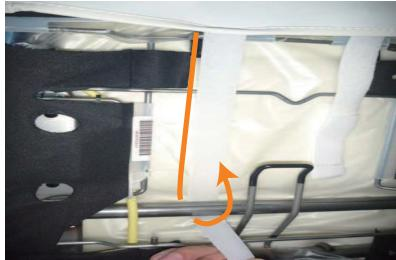
7 カバーの上下にはマジックテープが付いています。（上：2ヶ所、下：1ヶ所）マジックテープをシート背面の金属部に巻きつけ、マジックテープ同士を貼り合わせて固定します。この時、上下の生地がしっかりと張るように調節しながら、マジックテープを固定します。
