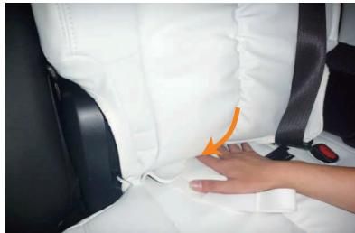
4 座面と背もたれの隙間に生地を入れ込みます。背もたれの角度を調節して入れ込みやすい位置で行って下さい。
