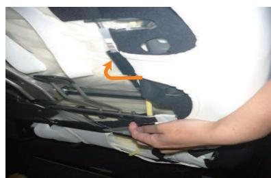
9 8番と同様に側面のプラフックもシート背面の金属に引っ掛けで固定します。
