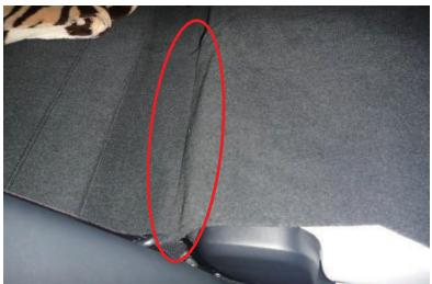
2 片側の背もたれを前に倒して背面の隙間から（図の○部分）先に固定を外します。
