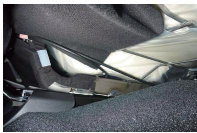
16 シートの底面を内側から見た図です。底面には金属の骨組みがいくつある為、ゴムが届く金属部分にフックを引っ掛けます。
