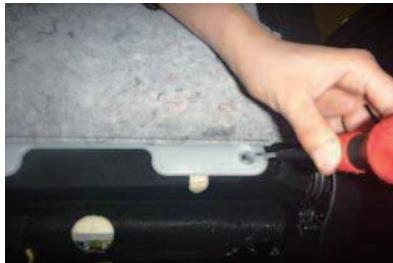
4 プラスドライバーでネジを取り外します。
