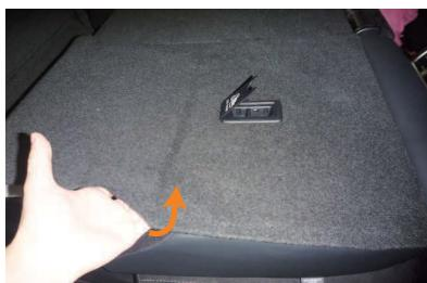
5 バックボードを取り外します。バックボードの隙間に、手を入れてビスを引き抜きます。
