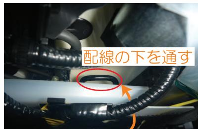
6 図の様に配線がある部分は配線の下を通してマジックテープを固定して下さい。
