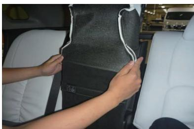
2 カバーを3分の2程折り返して、アームレストにかぶせます。カバーにベルトが付いている方が前側になります。
