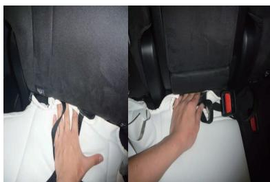
11 生地を座面と背もたれの隙間に入れ込みます。背もたれの角度を調節して入れ込みやすい位置で作業を行って下さい。
