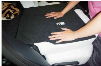
11 バックボードを外した逆の手順で元に戻します。バックボード上部に付いているツメを先に引っ掛け、ビスとシート側の穴位置を合わせ、上から押してはめ込みます。チャイルドシート用アンカーは最後に戻します。
