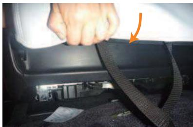
11 カバーの前側に付いているベルトをシートと樹脂の隙間に入れ込みます。
