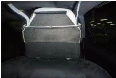
1 カバーを半分程折り返して、ヘッドレストのラインに合わせてかぶせます。平らなプラスチックが付いている方が前側です。
