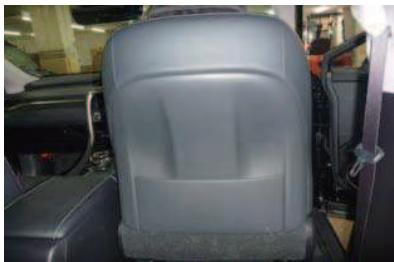
1 カバーを取り付ける前に、バックボードを取り外します。
