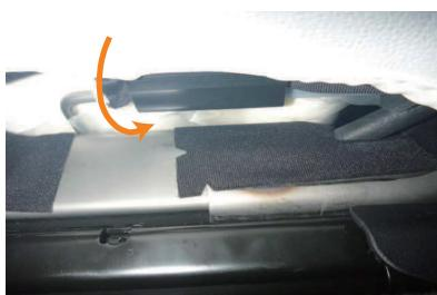
18 シート底面の図です。金属の骨組み部分に純正のプラスチックパーツが付いている所があります。プラスチックパーツの上からカバーのプラフックを引っ掛けます。
