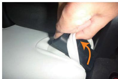
22 カバー奥に付いているゴムを中央のシートベルトバックルに通して固定します。カバーのラインを整えて、運転席側座面の完成です。助手席側は一部固定方法が異なる為
