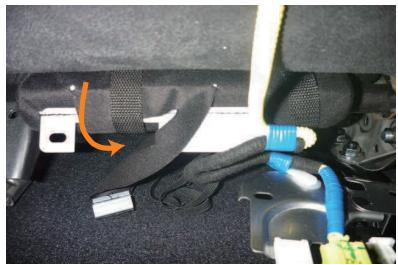
13 引き出した生地の先端に付いているベルトをシート底面を通して前側へ回します。
