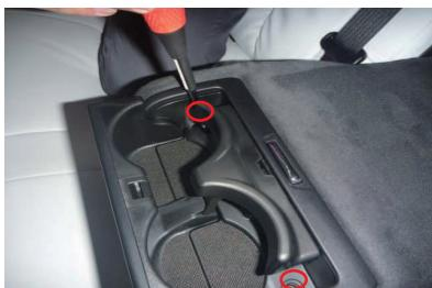
1 アームレストに付いているカップホルダーを取り外します。ネジで固定されているのでプラスドライバーを使用して取り外してください。
