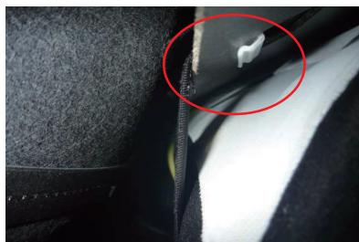
4 ゴムを取り外した後、背もたれ背面下部に図の様なプラスチックのツメがボードに固定されています。このツメも取り外します。
