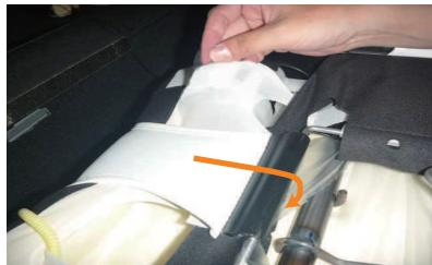
8 6番で引き出した生地に付いているプラフックを、シート背面の金属部分に引っ掛けで固定します。
