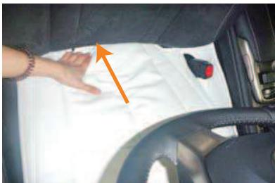
9 座面と背もたれの隙間に生地を入れ込みます。背もたれの角度を調節して、入れ込みやすい位置で作業を行って下さい。
