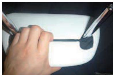
4 カバー底面のプラフックを留めて固定します。
