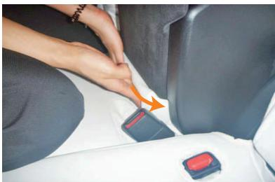
8 アームレストの位置を調節しながら下に隙間を作り、元の位置に押し込み戻します。背面のボルトの穴位置を確認しながら戻してください。
