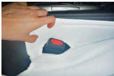
8 カバー内側の加工穴からシートベルトのバックルを取り出します。
