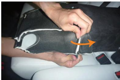
3 カバーを全体にかぶせます。アームレストの構造上、カバーのサイズが一部タイトになっています。左右交互に少しずつ力を入れながらカバーを下げます。無理に力をかけるとカバーが裂ける恐れがあるので慎重に作業を行って下さい。
