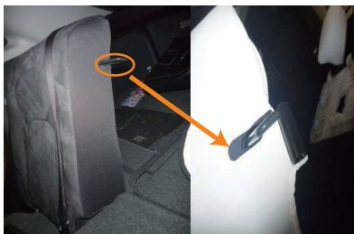
2 運転席側には図の様なアンカーが付いている為、カバーの加工穴に通します。
