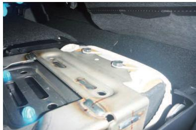
10 緩めに締めたボルトの隙間にカバーの先端に付いているゴムを引っ掛けて、再度ボルトをしっかりと締めます。
