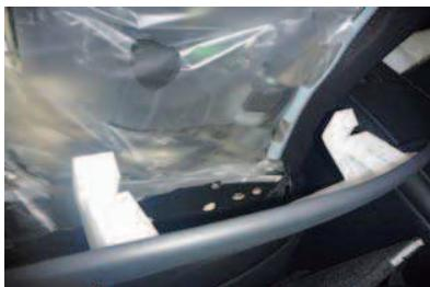
5 バックボードを取り外します。バックボードは図の様に樹脂のツメをシートに引っ掛けて固定されています。バックボードの両サイドを持ち、片側づつ真下に引き下げる様に取り外します。
