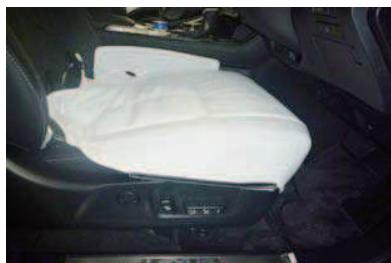
7 シートリフターを最大まで上げて、カバーをシートのラインに合わせてかぶせます。
