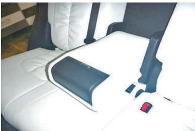
9 カップホルダーを外した逆の手順で元に戻し、カバーのラインを整えて2列目アームレストの完成です。
