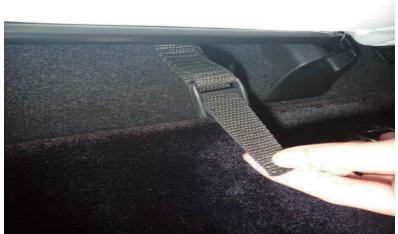
14 13番で前側に回したベルトをカバー前側に付いているバックルと固定します。
