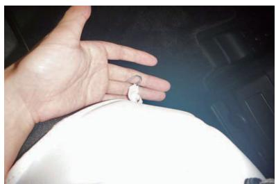
15 カバー内側の下部にはゴムが付いています。ゴムの先端に付属の金属フックを取り付け、シート底面の金属部分に引っ掛けで固定します。
