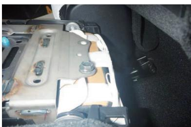
9 背面のボルトを締めます。この時、しっかりと締めずに少し緩めに締めます。
