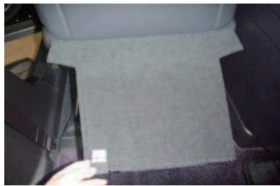
2 バックボード下の生地はシートの座面裏で固定されています。座面裏の金属部にプラスチックで固定されているので取り外します。
