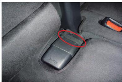
8 座面中央のシートベルトバックルはゴムで固定されています。このゴムも取り外しておきます。
