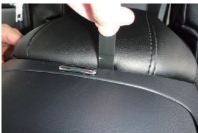
7 ドリンクホルダー部の周囲全てに生地を入れ込みます。
