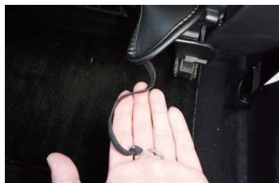
11 5ページ6番で引き出した生地には、ゴムも付いていますので、付属の金属フックを取り付け、シート底面の金属部に引っ掛け固定します。
