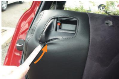
4 シートのリクライニングレバー部分をカバーの加工穴から取り出し、リクライニングレバーの隙間に生地を入れ込みます。
