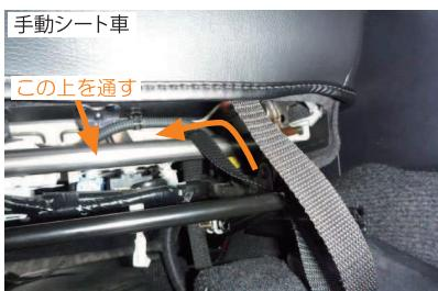
9 カバー前側に付いているベルトをシートの底面を通して、後ろ側へ引き出します。
