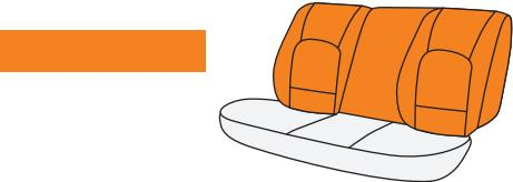
13 背面にあるチャイルドシート固定用フック部の隙間に生地を入れ込みます。
