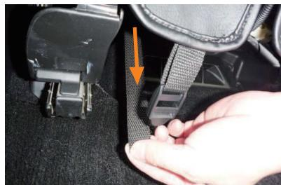
10 後ろ側から引き出したベルトは、5ページ6番で引き出した生地に付いているバックルに通し固定します。
