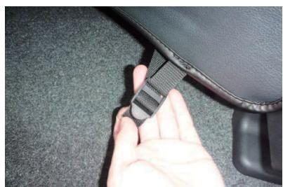
2 バックルにベルトを通して、引き絞る事で、カバーが固定されます。
