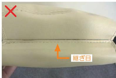
5 間違った固定をすると、カバーの継ぎ目に図のように板状のプラフックの縫製糸が見えてしまいます。
