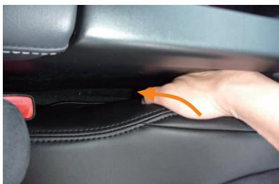
8 カバー内側面の生地に付いているマジックテープを、シート本体に直接貼り付け固定します。
