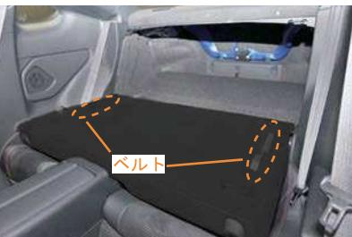
8 背面のベルトをカバーの加工穴から取り出します。
