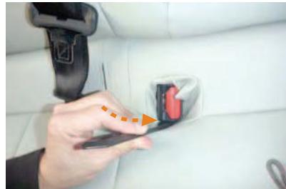
17 シートベルトバックルの収納部にヘラなどを使用して生地を入れ込みます。
