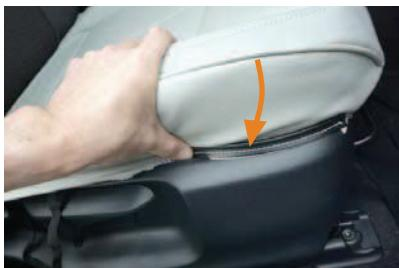
9 カバー外側面の生地をシートとプラスチク部の隙間に入れ込み固定します。
