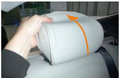
8 2列目ヘッドレストです。2列目ヘッドレストは図の矢印方向に、ヘッドレストのラインに合わせて下から上へかぶせます。カバーは平らなプラスチックが付いている方が前です。
