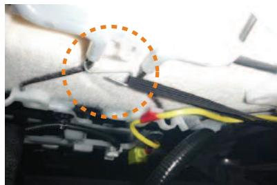
12 ゴムに付属の金属フックを付けて、シート裏の金属部分に引っ掛けて固定します。
