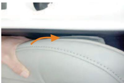
14 カバー内側面の裏側に付いているマジックテープを、直接シートに貼り付けて固定します。5ページ2番の説明にもあるようにマジックテープに保護テープが付いている場合はそちらを外し固定して下さい。
