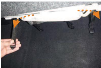
8 5ページ6番で入れ込んだベルトを引き出します。ベルトは配線の外側に来るよう中央部分から端へすらします。ベルト部分は強く引き過ぎると生地が破れるので、ご注意下さい。
