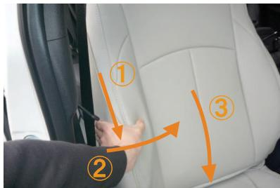
10 カバー側面の生地を、図の①～③の順番でシートに密着させていくようにして、シワをなくして下さい。側面の生地がしっかりと張るまで繰り返し行って下さい。
