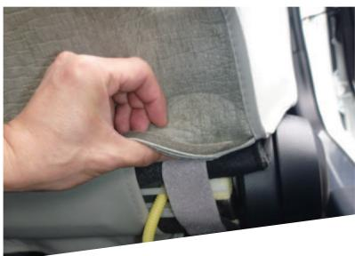
14 10ページ8番で引き出したマジックテープとカバーの背面下を固定します。引き出したマジックテープは長めに設計しています。丁度良い位置で固定して下さい。
