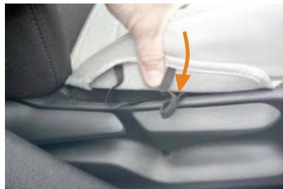
10 運転席側のカバー外側面後ろ側にゴムが付いています。ゴムをシートとプラスチック部の隙間に入れ込みます。
