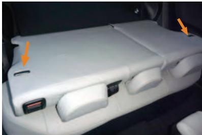
20 図のシートを固定する受けの部分にカバーの加工穴があっているか確認して下さい。加工穴は少し大きめに開けていますが、すりで受け部分を塞いで使用すると、生地が破れる恐れがあるので、ご注意下さい。
