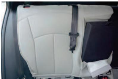
4 アームレストを斜めに倒してカバーの加工穴から出します。
