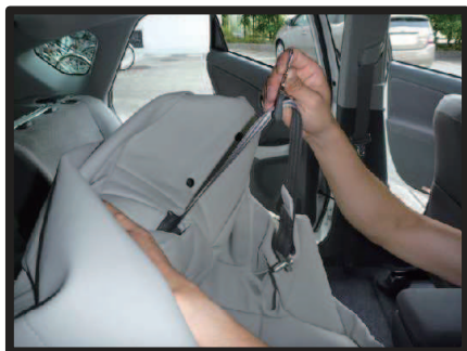
④カバーの加工穴からシートベルトを取り出します。
