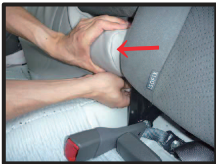
⑧背もたれの付け根にあたるアームレスト下の側面部分に生地を入れ込みます。
