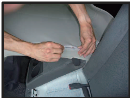
⑩ 内側側面下のファスナーを閉じます。ファスナーを閉じる際は生地を内へ寄せながら慎重に閉じて下さい。
