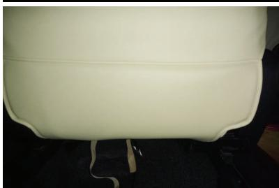
15 カバー背面下部の生地に付いているゴムに付属のS字フックを取り付けシート底部に固定します。
