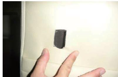
4 付けた印に沿ってカバーを切り抜きます。生地を切り抜く際は、シートを切らないようご注意下さい。
