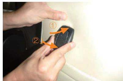
5 穴あけ加工した部分にフックを押し込み、元に戻します。①先にフックの上側のツメを引っ掛け、②下側を押し込むようにして下さい。
