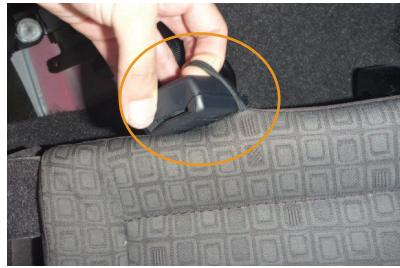
1 中央席用のシートベルトバックルを外します。シートに付いているゴムで固定されていますので外して下さい。
