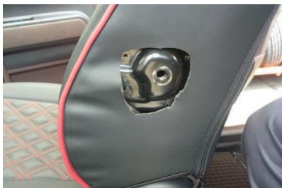
17 切れ目から少しづつ、図の大きさ程まで穴を広げます。外した時とは逆の順序で、アームレストの台座をシートに戻します。
