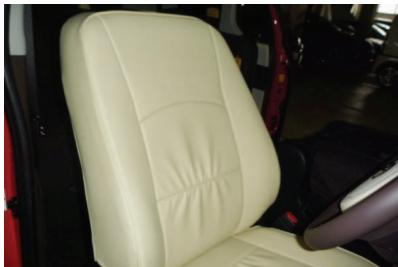
18 サイドエアバッグ装備車は、サイドエアバッグの展開部分とシートカバーのSAB対応の縫い目部分が合っていることを確認してください。
