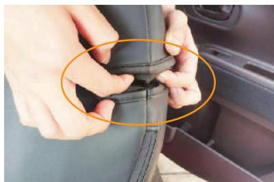
11 カバーの加工穴をシート背面の固定具位置に合わせます。
