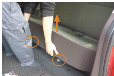
3 座面を持ち上げるようにして、図の○部分にあるツメの固定を外します。
