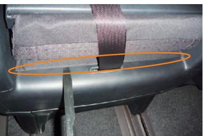
9 座面後ろ側の○部にカバーを固定します。
