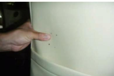
3 カバー装着後、フックが固定されていた穴位置を確認して、穴のチフチに沿って印を付けてます。
