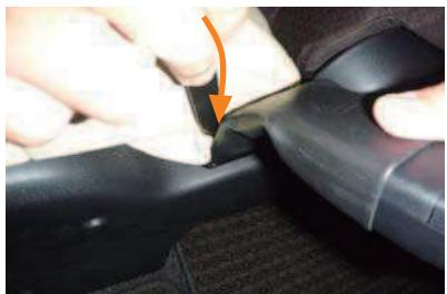
7 シートベルト部の隙間に生地を入れ込みます。
