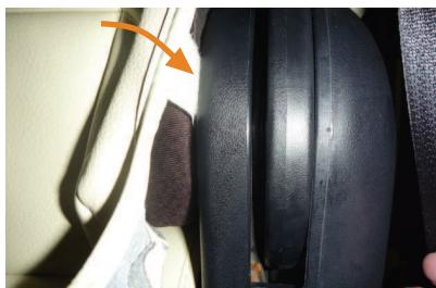
9 カバー両側面の生地には長めのマジックテープが付いています。マジックテープをシートのヒンジ部の隙間を通して、後ろ側へ引き出します。
