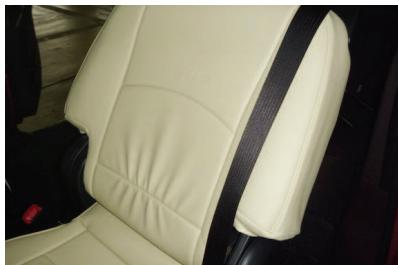
15 サイドエアバッグ装備車は、サイドエアバッグの展開部分とシートカバーのSAB対応の縫い目部分が合っていることを確認して下さい。
