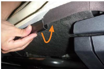
3 カバー前側に付いているプラフックをシートに直接引っ掛け、固定します。
