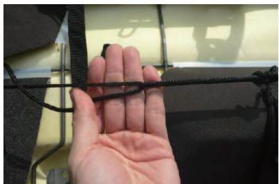
11 カバーの端から出ているヒモの片方で輪を作り、もう片方のヒモを通します。
