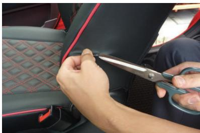
16 オプションアームレスト付きの場合はアームレストが固定されていた穴位置を確認して、穴のフチに沿って印を付け、はさみなどでカバーに切れ目を入れます。
