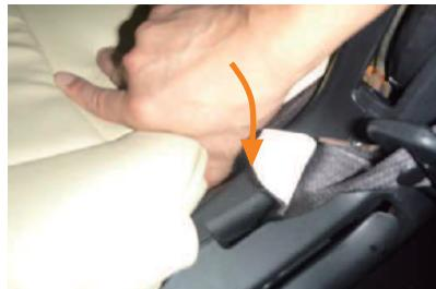
5 カバー両側面の背もたれ付け根付近の生地にはゴムが付いていますので、付属のS字フックを取り付け、図のようにシートの隙間に入れ込みます。
