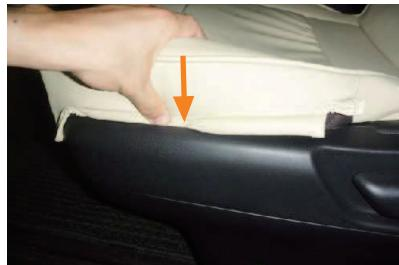
4 カバー外側面の生地を、シートとプラスチック部の隙間に入れ込みます。
