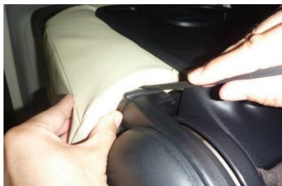
8 背もたれ付け根部分の生地もシートの隙間に入れ込みます。
