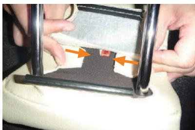
9 ヘッドレストをシートから外し、ヘッドレスト裏で、カバーを内側へ寄せながらマジックテープを留めます。
