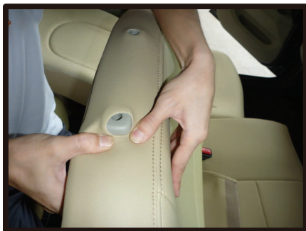
⑦ ヘッドレストの台座部分を穴から取り出します。生地の伸びを利用して横からもぐり込ますように取り出して下さい。無理に入ると破れる恐れがありますのでご注意ください。
