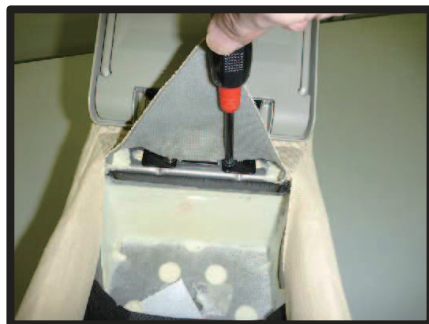
③上蓋を外します。 ヒンジ部分のネジをドライバーで外 します。
