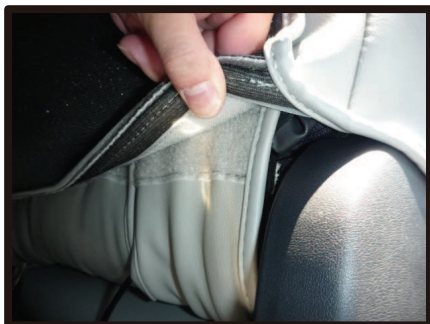
⑮5ページ⑩で引き出した生地と、背もたれ背面の生地をマジックテープで固定します。
