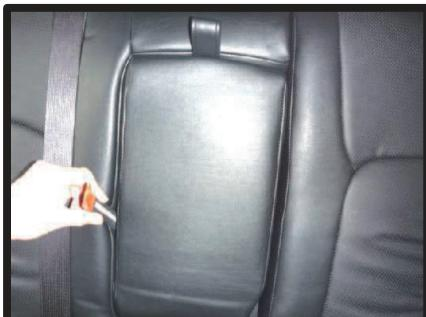
⑭アームレスト収納部のシワを無くしシートに早く馴染ませるために、カバー取り付け後アームレストをしっかりシートに収納させヘラ等で内部の生地を整えて一週間ほどそのままの状態を保っていただくと生地に型が付き、シワが解消されます。
