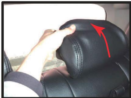
①2列目中央ヘッドレストは、先端から矢印方向へかぶせていきます。
