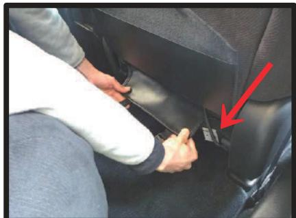
⑤入れ込んだ生地をシート背面から引き出します。矢印部分にサイドエアバッグの配線が出てますので、配線をかわして生地を引き出して下さい。
