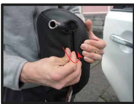
③シートからヘッドレストを外し、ヘッドレスト裏でプラスチックのフックで固定します。
