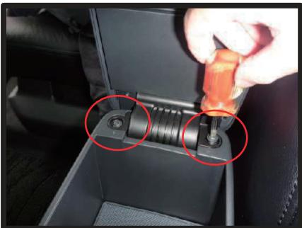
①アームレストは上ブタのモケット部分のみカバーをかぶせます。上ブタを外します。上ブタを開け図のネジをドライバーで外すと外れます。※上ブタは外さなくともアームレストの取り付けは出来ますが、外した方が作業が行ないやすくなります。
