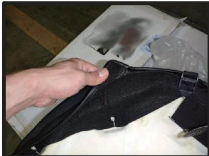
④シートを裏返して、側面の生地をシート裏の本体にマジックテープで固定します。
