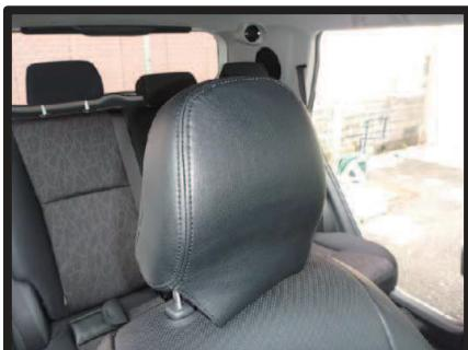
②ヘッドレストのラインからはずれないようにカバーをヘッドレスト全体にかぶせます。
