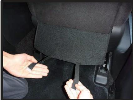
①始めてシート背面からシート裏にかぶっているカバーを外します。カバーはフック2カ所でシート裏の金属部分に引っ掛け固定されています。
