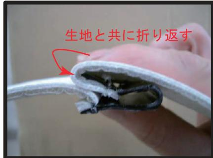
④プラスチックフックの固定方法はカギ状のフックに平らな方のプラスチックを生地と共ににはめ込み固定します。
