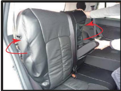
①カバー背面のファスナーを開けて、シートに矢印方向へ巻き付けるようかぶせます。この際、アームレストはカバーの加工穴から取り出します。
