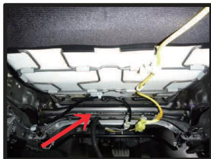
⑨カバー前方に付いているベルトをシート裏を通してシート背面から引き出します。この際ベルトは、スライドレバー、矢印の金属部分の上を通してください。（シート背面からの図）
