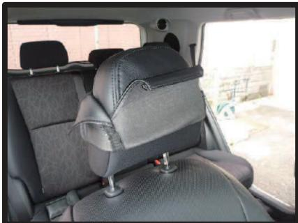
①カバーをヘッドレストのラインに合わせて、半分ほど裏返してヘッドレストにかぶせます。この際、ヘッドレストの頂点までしっかりとかぶせて下さい。
