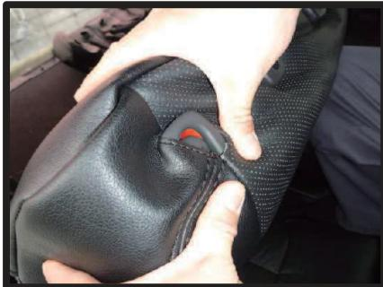
②リクライニングボタン、ヘッドレストの台座をカバーの加工穴から取り出します。
