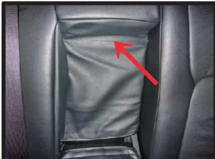
⑬アームレスト収納部の図です。カバー取り付け後すぐは生地が馴染まないためシワがあります。矢印部分の生地裏に収納部の形が形成されやすいようにプラスチックの板が付いています。
