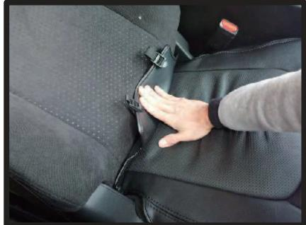
④背もたれと座面の隙間に生地を入れ込みます。背もたれの角度を調整して入れ込みやすい位置で行って下さい。
