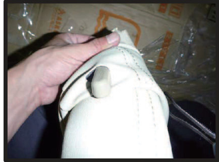
②ヘッドレスト側面のレバーを、カバーの加工穴から出します。
