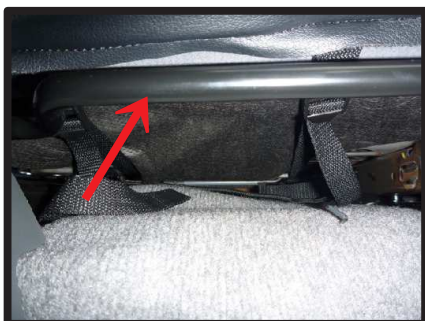
⑬ベルトはスライドレバーの上を通して固定するようにして下さい。
