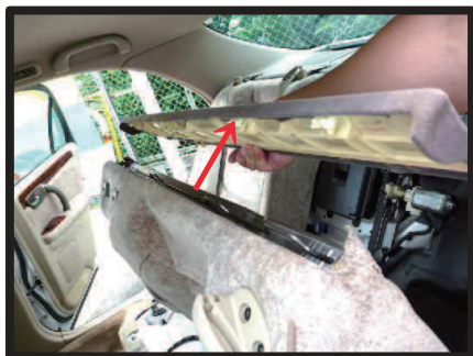
⑦背もたれ上部には、図のようなフラップが付いていますので、取り外します。
