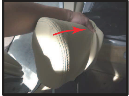
⑩2列目ヘッドレストは、まず片側にカバーをかぶせます。この際、しっかりとラインに合わせてるようにします。
