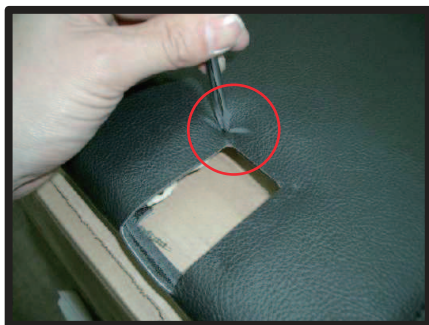
⑮カバーのレバー部のネジや突起部のある場所に、あらかじめ穴を開けておきます。
