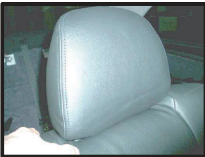
⑨ヘッドレストをシートに取り付けて完成です。 2列目中央ヘッドレストも一部形状が異なりますが、同様に取り付けます。
