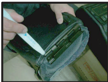
⑯ボックスとの繋ぎ目周辺のカバーは金具の下側に潜り込ませます。 (金具が自由に動く程度に潜り込ませます。)
