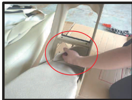
⑥取り外したアームレストを車外に運び出し、図のようにアームレストの生地を、プラスチックパーツから取り外します。
