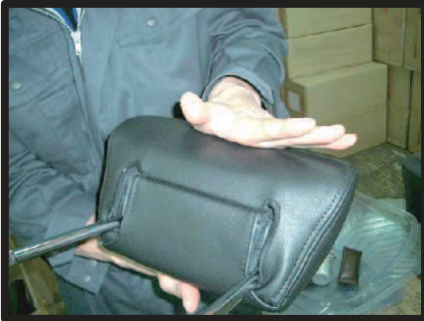
⑧19ページ②・③で、ヘッドレスト本体を圧縮しましたので、手のひらでたくようにしてカバーの中身をならしていきます。
