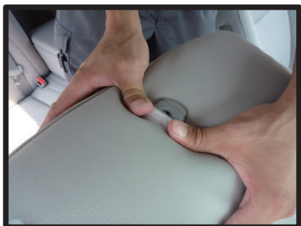
⑥ヘッドレストの台座部分を穴から取り出します。生地伸びを利用して横からもぐり込ますように取り出して下さい。無理に入れると破れる恐れがありますのでご注意下さい。
