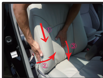
⑧矢印の①～③の順にカバーをシートに馴染ませ、形を整えます。
