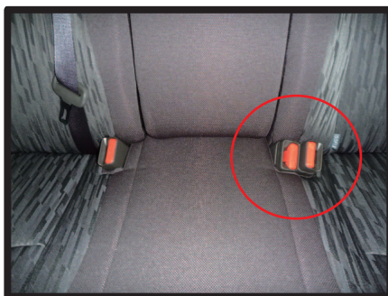
H21.4以降の車 (1420・1421) 座面○部のシートベルトバックルが横に並んでいます。
