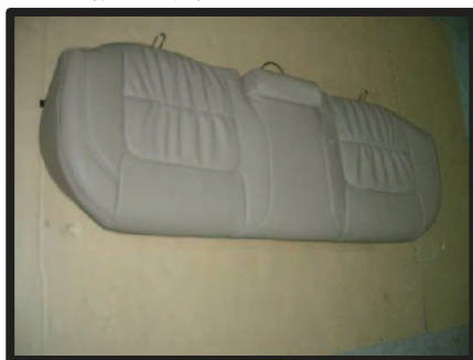
⑥カバー表面を整え、2列目座面の完成です。 座面は、背もたれ側のカバーを装着後に、車体に戻します。
