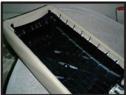
⑤フタを裏返し、内側にカバーを巻き込んでいきます。
