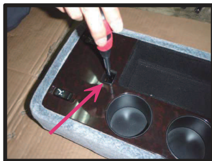
⑥ 下パーツのボックスを外します。 図のカップホルダーの上にネジがありますので外します。
