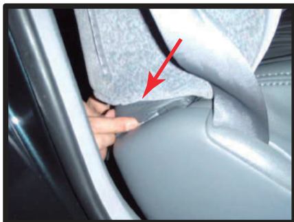
⑤側面の生地はプラスチックカバーの間を通し、後ろに引き出します。
