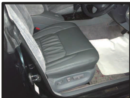
⑪カバーのラインを整えます。1列目座面の完成です。助手席側も同様に取り付けます。
