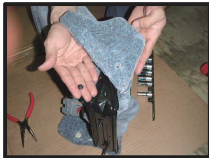
④ 側面のパーツを外します。 小さなナットで固定されています。
