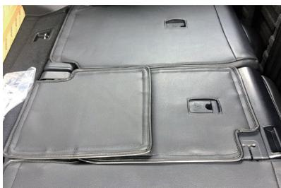
12 アームレストを固定しているシート背面です。シートカバーのパーツタグ『20AR中央』と印字してある平面のパーツを、図のようにシート背面の形状に合わせて、マジックテープを直接シートに貼り付けて固定します。
