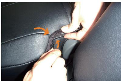
7 アームレストの付け根部分でカバー側面のファスナーを生地を内へ寄せながら、慎重に閉じます。ファスナーの端はカバーの内側へ入れ込みます。
