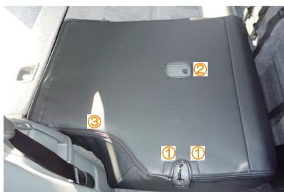
10 ①シートをロックする金具の周りに付いているマジックテープを、直接シートに貼り付けて固定します。
