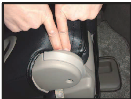
⑪アームレスト下側のプラスチック部分内側に生地を入れ込みます。
