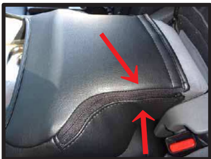
⑧アームレスト付け根部分のファスナーを閉じます。生地を矢印の方向へ寄せながら慎重に閉じて下さい。
