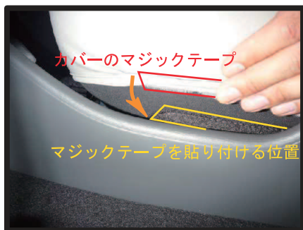
⑦カバー内側側面に付いているマジックテープを、シートに直接貼り付けて固定します。
