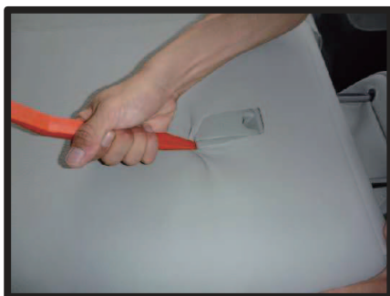
⑫ 背もたれ背面のチャイルドシート固定用バーをカバーの加工穴から取り出します。プラスチックのフチに生地を入れ込みます。
