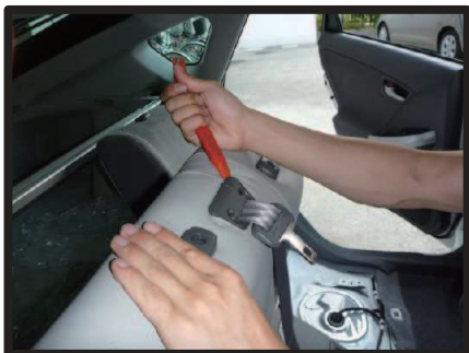
⑭シートベルトの台座を取り出します。台座のフチにヘラなどを使い生地を入れ込みます。
