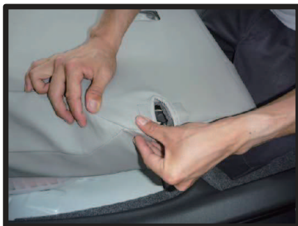
⑨ 背もたれを固定する金具をかわしてマジックテープをシート本体に貼り付け固定します。
