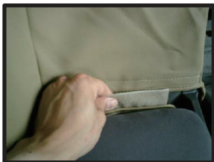
⑧入れ込んだ生地をアームレストを前に倒して引き出します。
