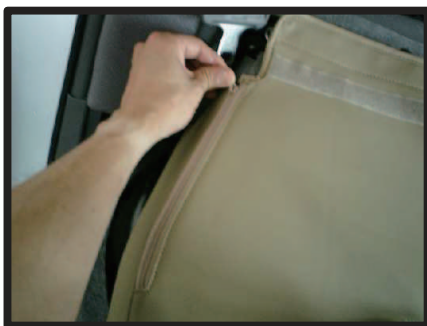
⑫背もたれ背面のファスナーを閉じます。ファスナーは無理せず生地を寄せ合いながら慎重に閉じて下さい。
