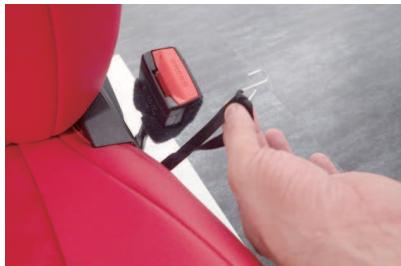
8 シートベルトバックル付近のゴムに、付属の金属フックを付け、座面裏に引っ掛けで固定します。この際、特定の位置はありません。ゴムにテンションがかかる位置で固定して下さい。
