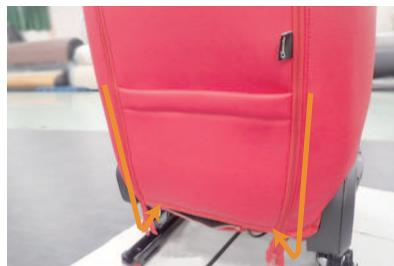
5 両側面のファスナーを閉じます。ファスナーの先端は、カバーの中に入れ込みます。
