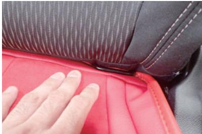
12 助手席はISO FIXチャイルドシート固定用の金具がありますので、シートと金具の隙間に生地を入れ込み金具を交わして下さい。
