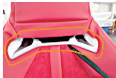
6 カバーをプラスチックパーツの隙間に入れ込みます。
