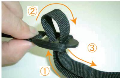
10 ベルトの通し方は、図の①～③の順番にベルトをバックルに通し、引く事でベルトが締り固定されます。
