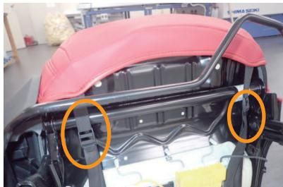
9 ⑨番で引き出したベルトを、座面底面を通して、座面前側にあるバックルと固定します。
