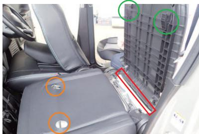
4 パックテーブルを取り外すと、このようになります。パックテーブル裏側の○位置のツメが、背もたれの○位置に固定されています。この状態でパックテーブルは取り外せていますが、□位置で純正表皮と繋がっています。
