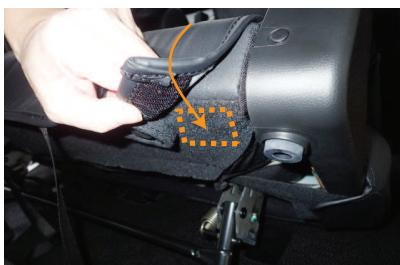
6 引き出した生地の両端に付いているマジックテープを、シート底面に直接貼り付け固定します。
