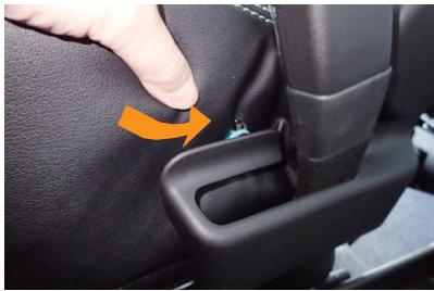
10 ⑨番でプラスチックパーツを浮かせて出来た隙間に、カバー内側面の生地を入れ込みます。
