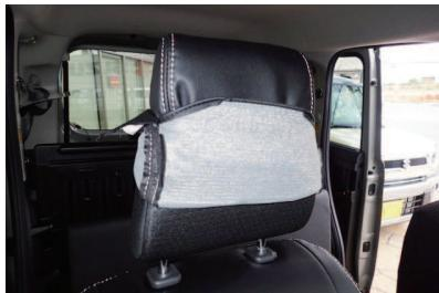
1 ヘッドレストをシートに固定した状態で、カバーを半分程度裏返し、ヘッドレストの先端がフィットするようにかぶせます。カバーは板状のプラスチックパーツが付いている方が前側になります。
