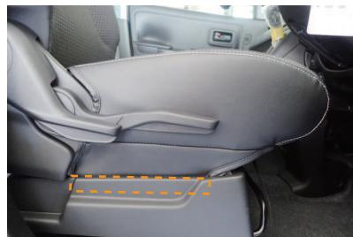
8 ②のマジックテープは、プラスチック部の隙間に入れ込んだ位置で、シートに直接貼り付け固定します。
