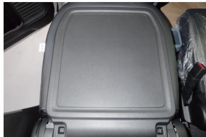
12 取り外した逆の手順で、バックボードを元に戻します。
