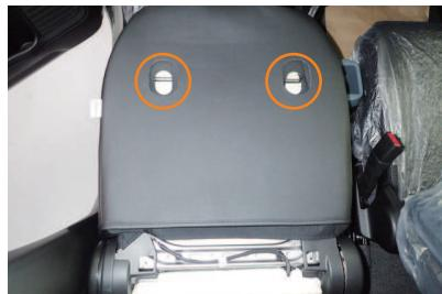
11 カバー背面の加工穴とバックボードの固定位置が合っている事を確認します。
