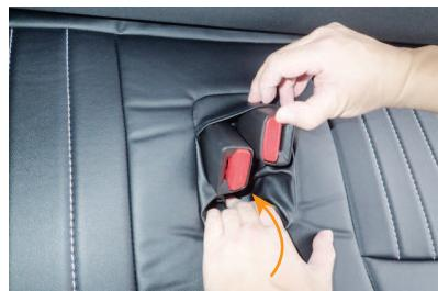
8 シートベルト収納部の隙間に生地を入れ込みます。
