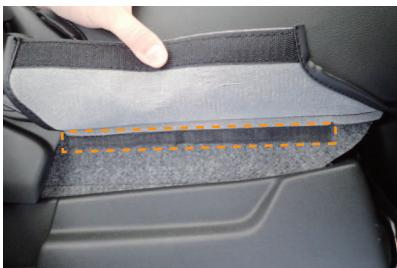
6 ①のマジックテープを、シートに直接貼り付け固定します。
