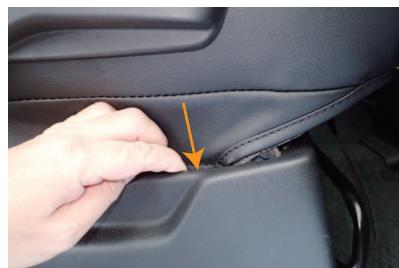
7 ②のマジックテープが付いている生地を、シートとプラスチック部の隙間に入れ込みます。
