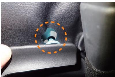
11 カバーの加工穴とプラスチックパーツの固定具位置が合っている事を確認し、プラスチックパーツを元に戻します。
