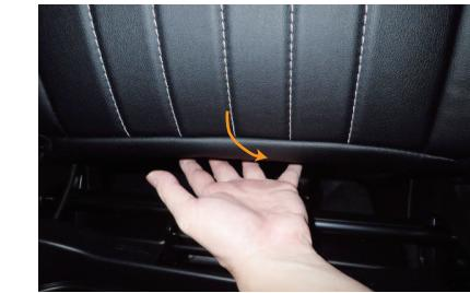
10 背もたれと座面の隙間に生地を入れ込みます。
